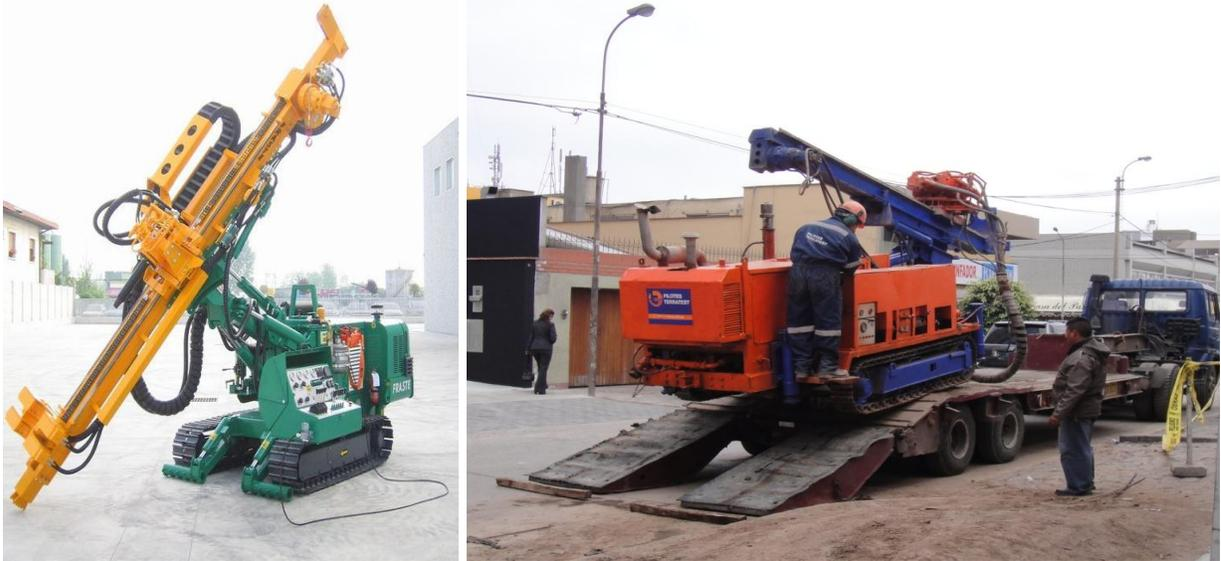
FOTOS 10 y 11: Máquinas Perforadoras – Inyectoras
