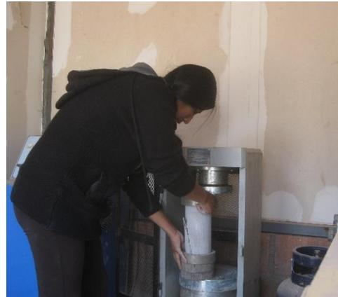
**FOTO 22 Observación directa de las rotura y fallas producidas.**
