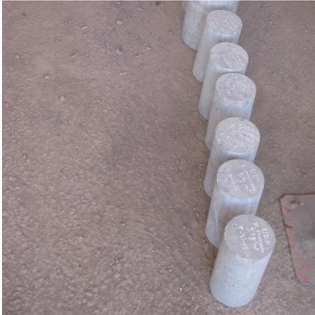
**FOTO 17 Colocado de briqueta.**
