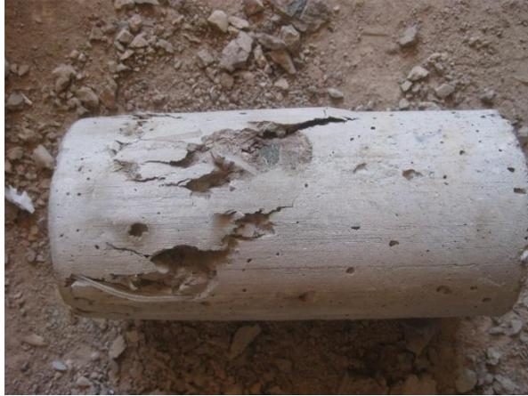
**FOTO 23 Fallas de briquetas con fibra**
