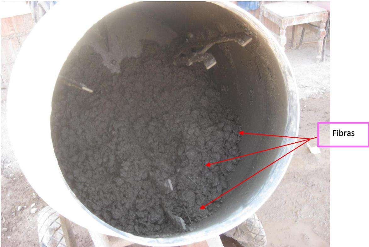
**FOTO 11 Slump de 3 cm; Obtenido en todas la mezclas**
