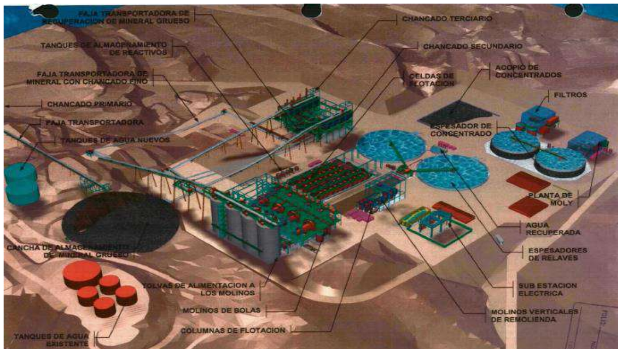
Figura N° 2: Distribución de estructuras de la Planta concentradora del Proyecto de Sulfuros Primarios PSP Enlozada,
