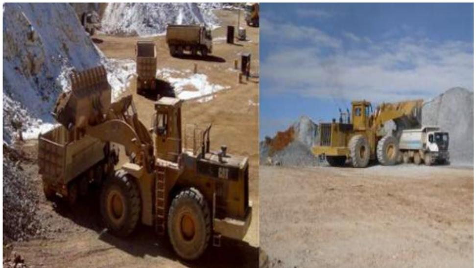
**Figura. 7.** Capacidad de lampones de  $3\text{m}^3$  y  $10.5\text{m}^3$ .
