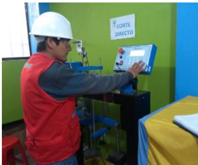
Fotografía N° 11: Ejecución del ensayo de corte directo.
