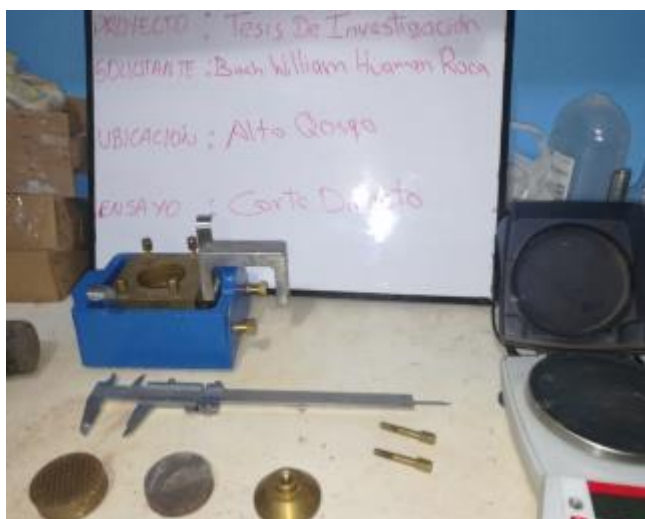
Fotografía N° 10: Caja de corte.
