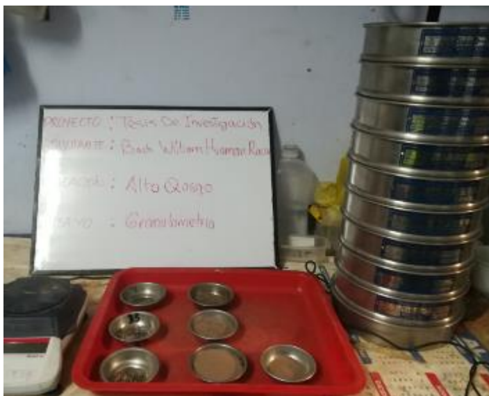
Pesado de las cantidades retenidas en los distintos tamices.
