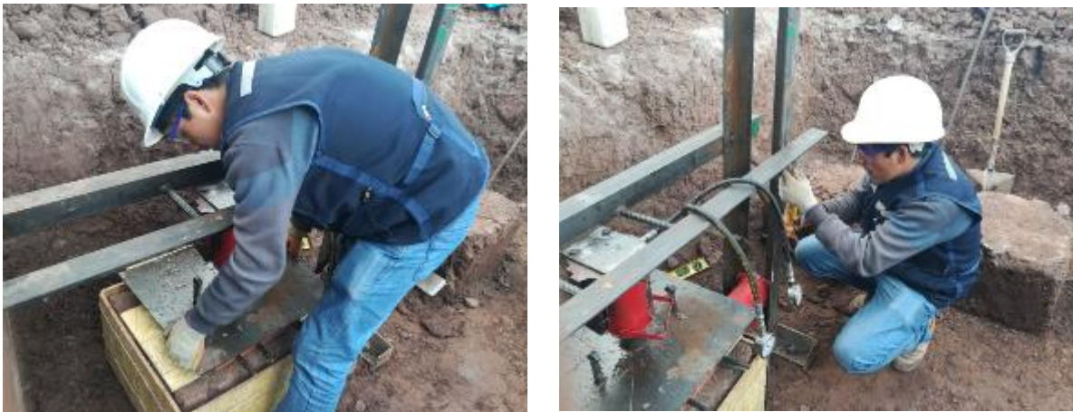
Fotografía N° 13 y N°14: Montaje del equipo de corte directo experimental
