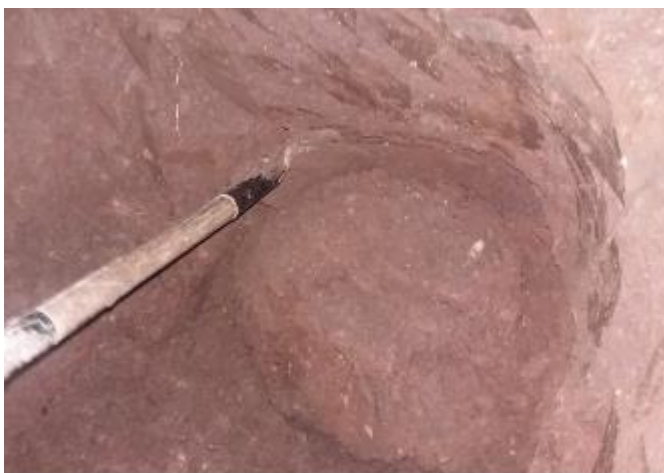
Fotografía N° 2: Extracción de muestra a 1.50m de profundidad.
