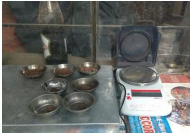
Fotografía N° 4: Tarado de muestras húmedas.
