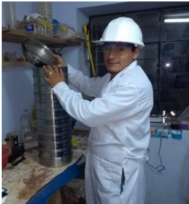
Tamizado del material con las mallas de 4", 2", 1", 3/8", N°4, N°10, N°40, N°100 y N°200.
