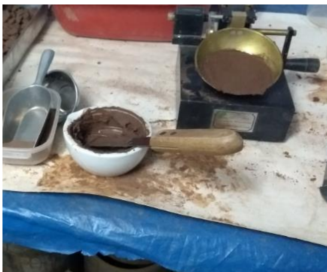
Realización del ensayo de límite líquido con el aparato de Casagrande.
