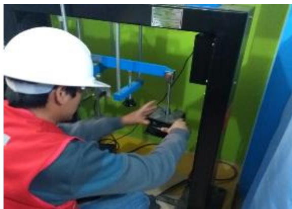
Figura 29: Colocado de carga en el equipo de corte directo
