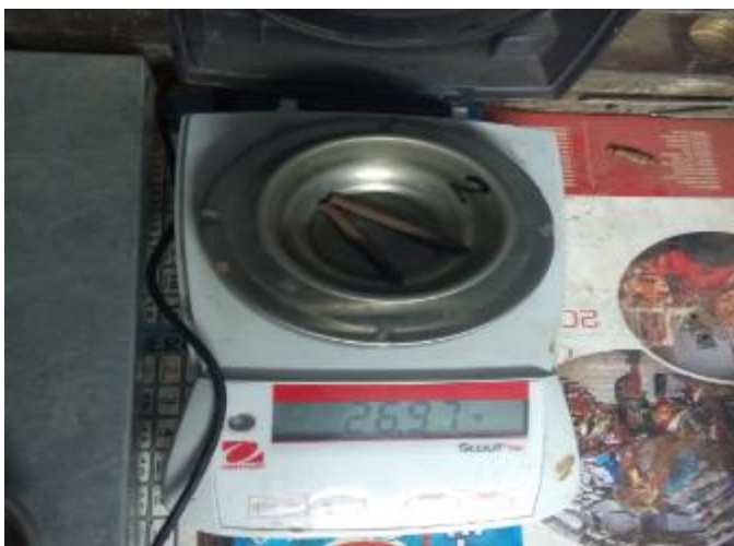
Fotografía N° 9: Pesado de muestras del límite plástico.
