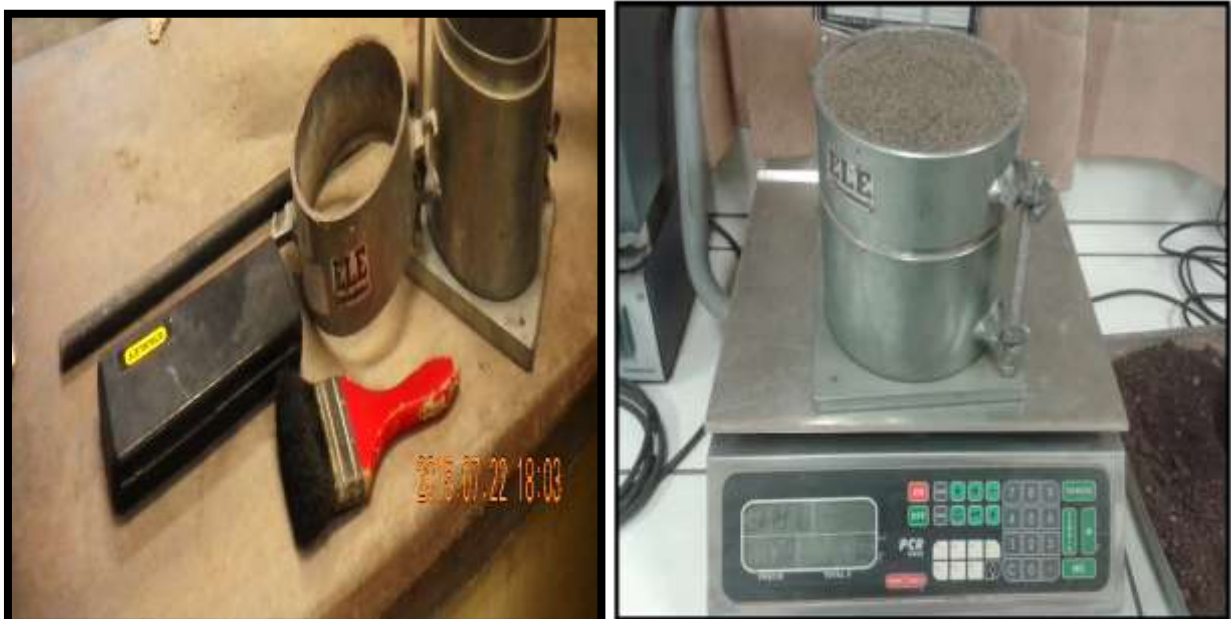
Figura 20 Equipo Empleado en el Ensayo y Toma de peso de Molde mas A.F
