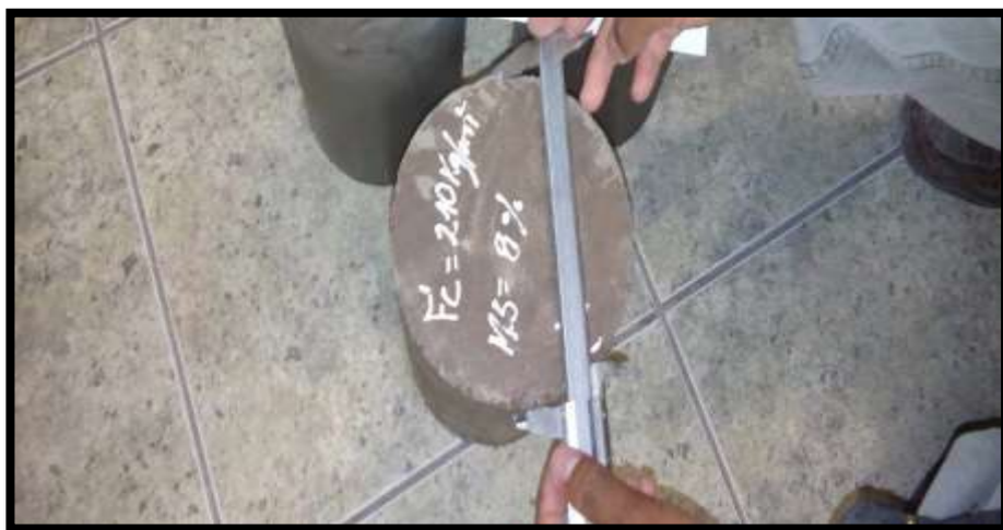
Figura 40: Medición de briquetas
