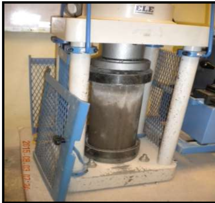
Figura 42 Briqueta de Concreto Sometida a cargas de compresion
