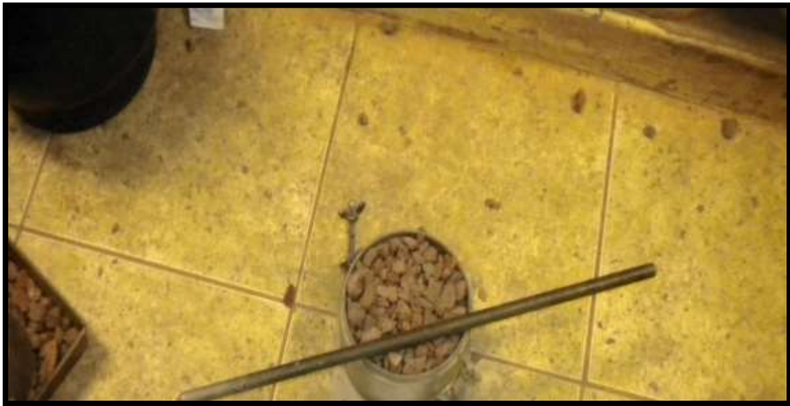
Figura 23 Enrasado de la Muestra Previa al Pesado
