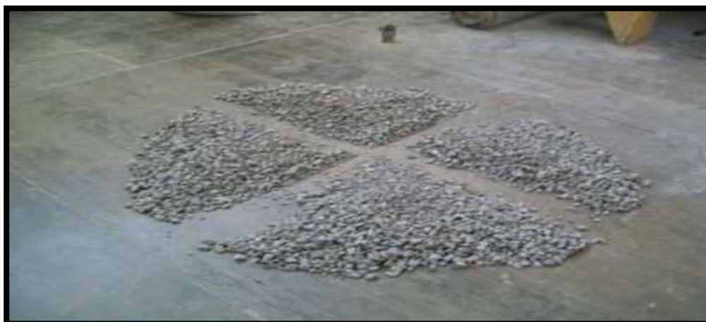
Figura 27 Cuarteo del Agregado grueso reciclado previo a los ensayos de laboratorio
