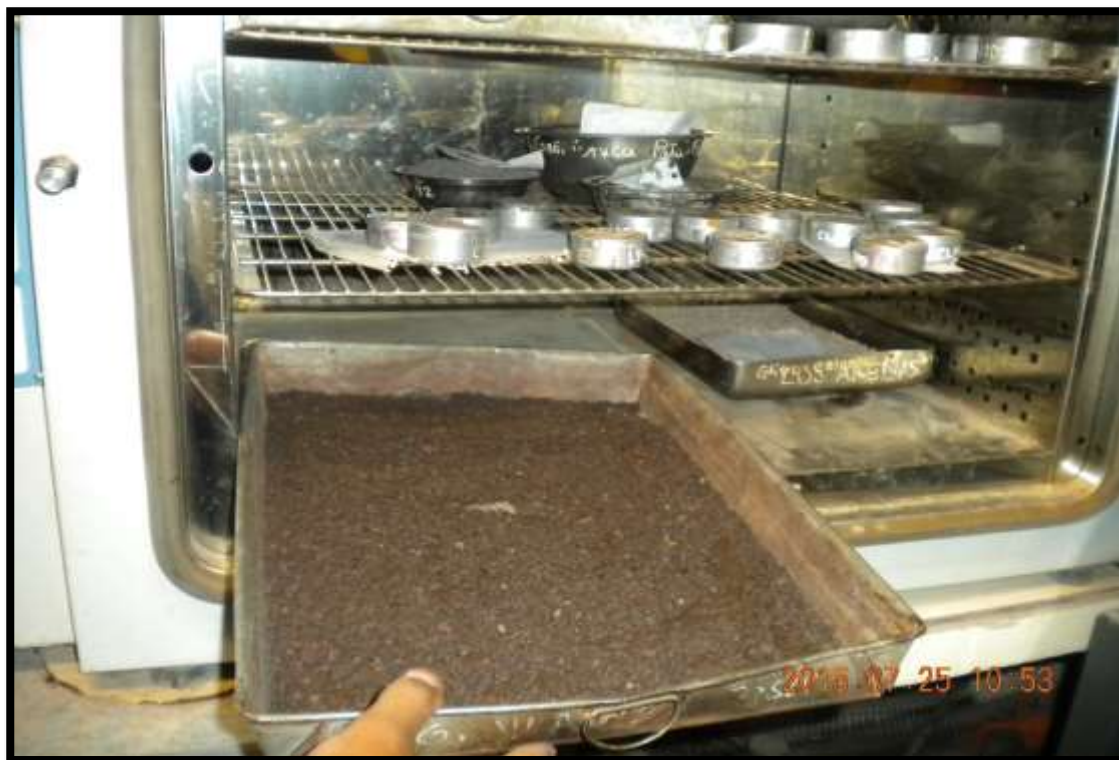
Figura 18 Secado del agregado grueso
