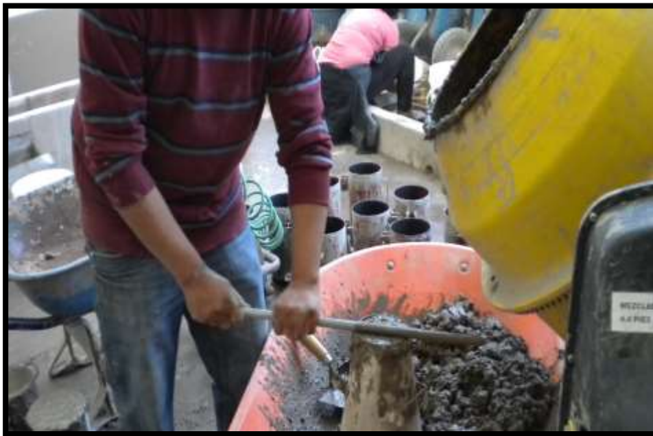
Figura 34 prueba del cono de brams
