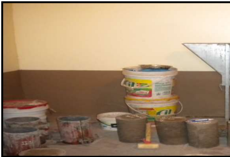
Figura 38 Extraccion de Testigos de Concreto de las Briquetas
