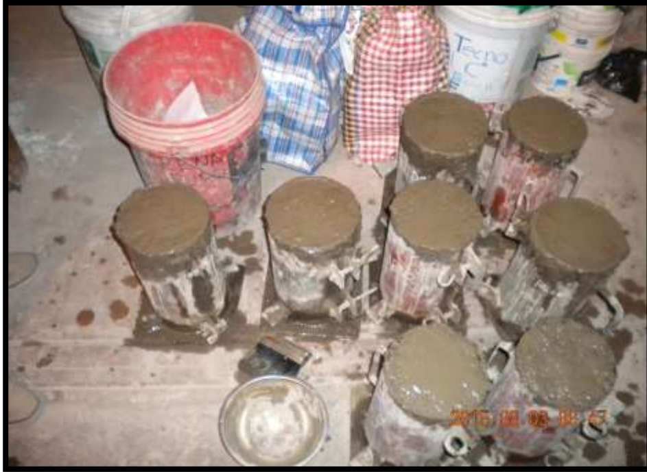
Figura 33 briquetas de concreto patrón
