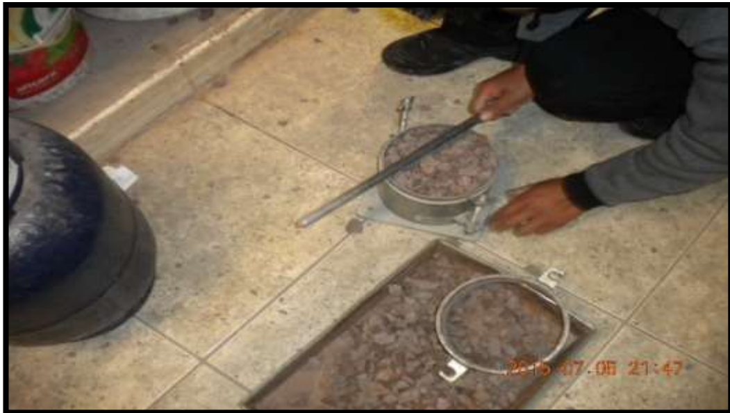
Figura 21 Material Grueso Colocado con caída Libre
