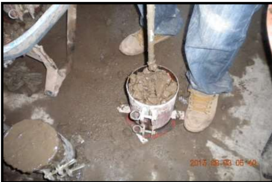
Figura 36 Chuseo de Testigos de Concreto
