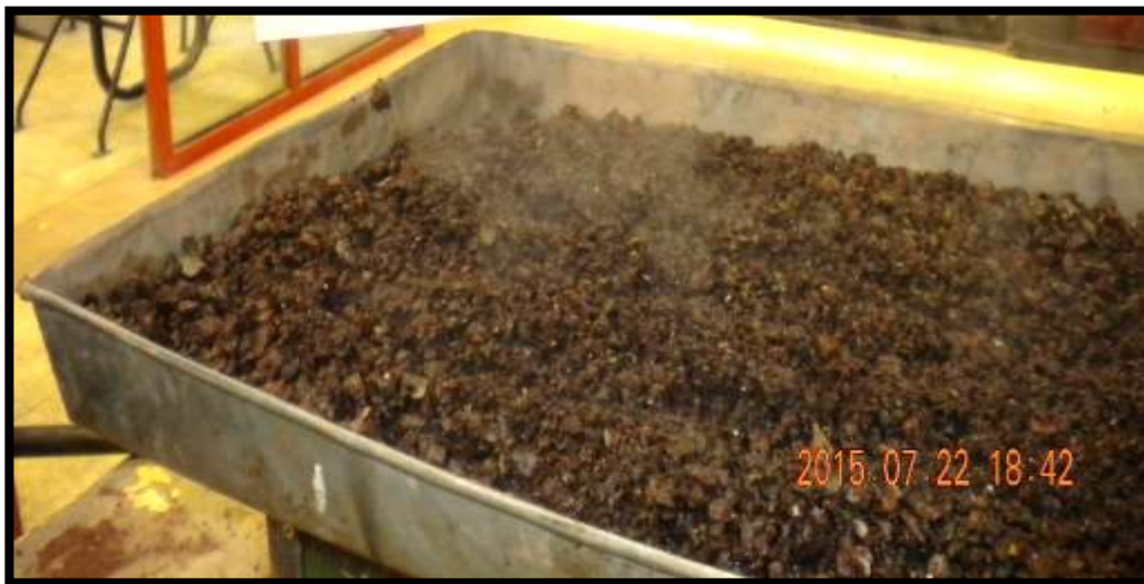
Figura 19 Secado de Material Fino Usando la Cocina a Gas
