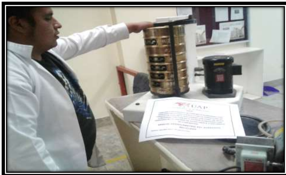
Figura 5 Maquina Tamizadora Realizando El Ensayo De Granulometría
