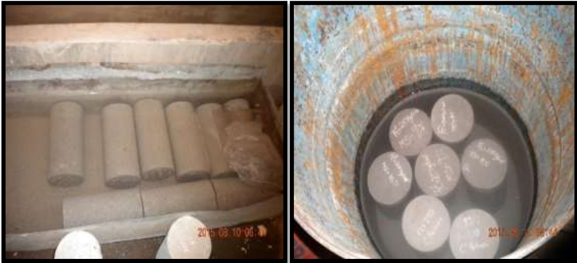
Figura 39 Curado de Testigos de Concreto
