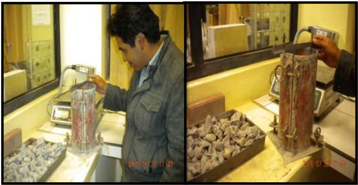
Figura 30 concreto reciclado en briquetera, ensayo de peso unitario compactado
