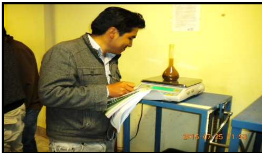
Figura 14 Toma del Peso del Picnómetro con A.F Libre de Aure.
