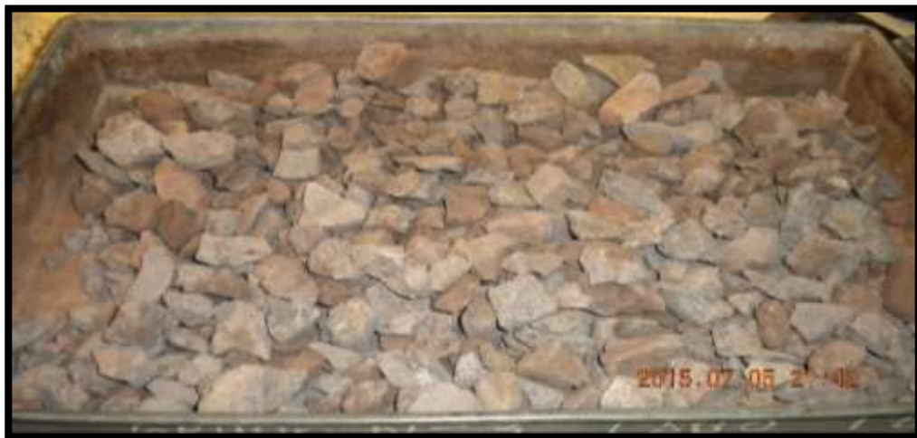
Figura 16 Secado de Agregado Grueso Mediante el uso de la Franela
