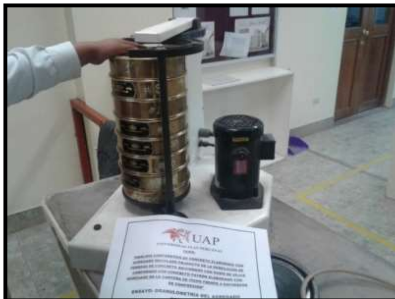
Figura 7 Tamices Normalizados para el Ensayo de Granulometría
