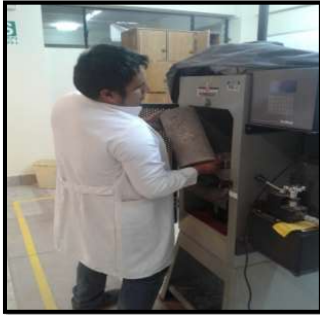
Figura 41: Colocación de Briquetas
