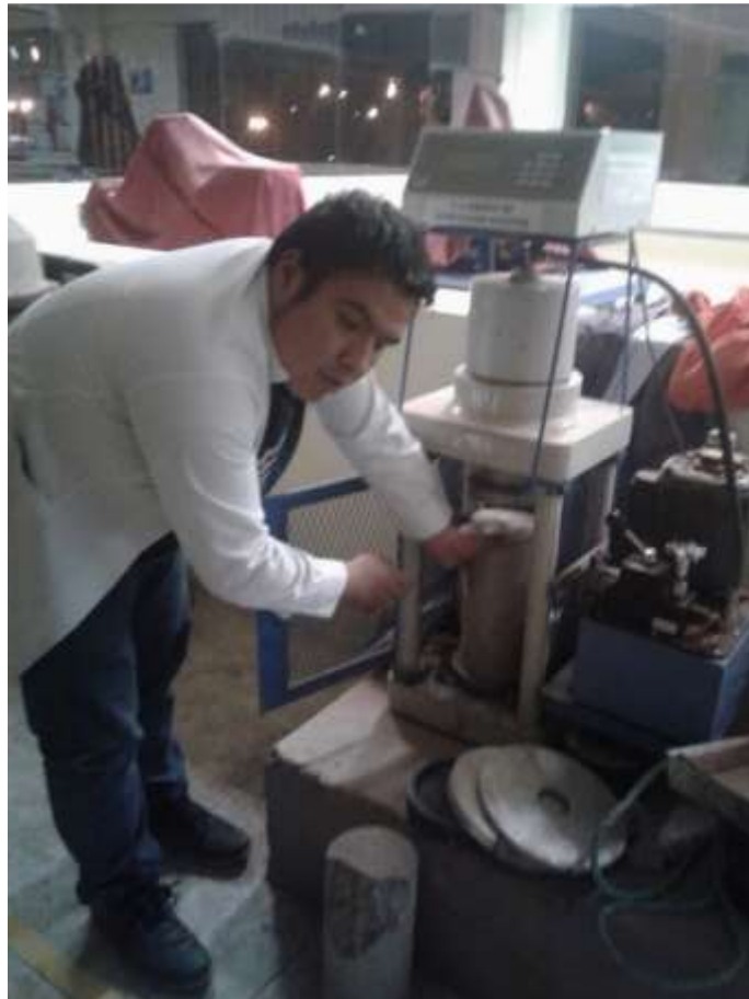
Figura 57. Rotura de briquetas de concreto
