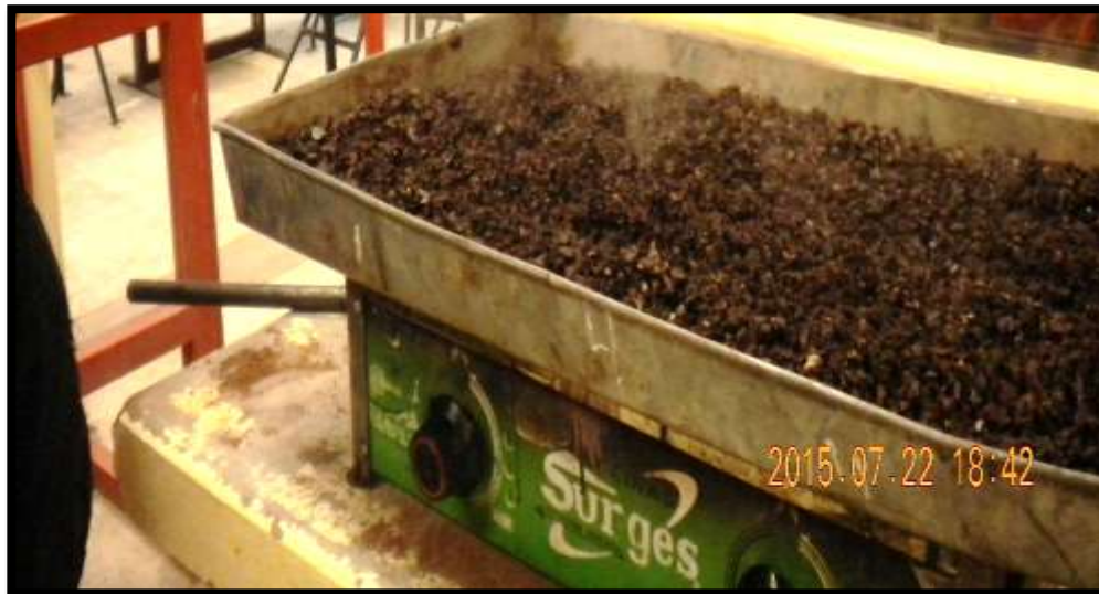
Figura 11 Secado de material fino mediante la cocina a gas
