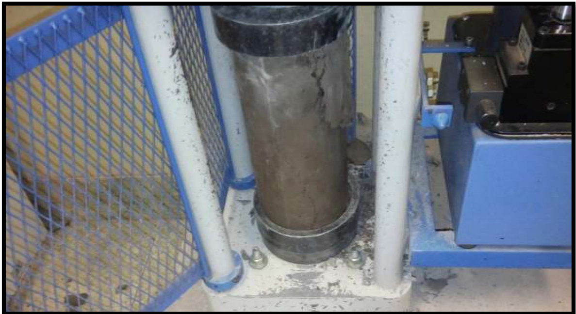
Figura 44 Briqueta de Concreto al Momento de la Falla.
