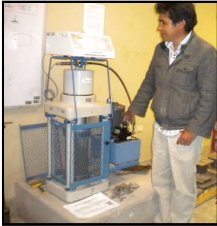
Figura 43 Rotura de Briquetas
