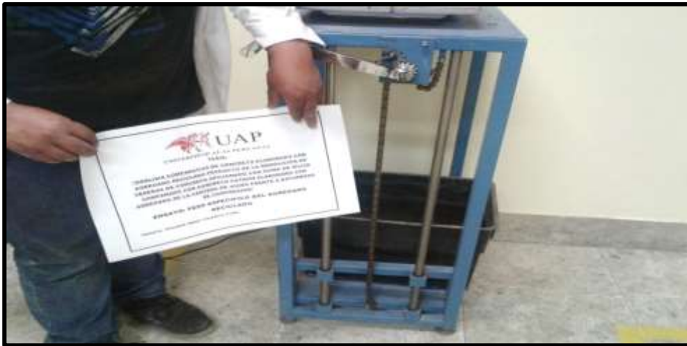
Figura 28 Agregado Reciclado Completamente Saturado Previo al Ensayo de Peso Específico Con Superficie Seca
