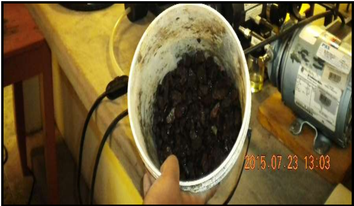
Figura 15 Agregado Grueso Saturado Previo al Ensayo de Peso Específico
