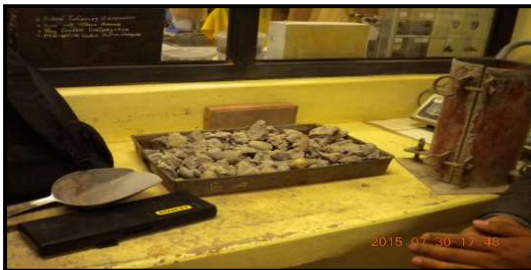
Figura 29 Agregado reciclado Libre de Impurezas previo al Ensayo de peso Unitario Suelto
