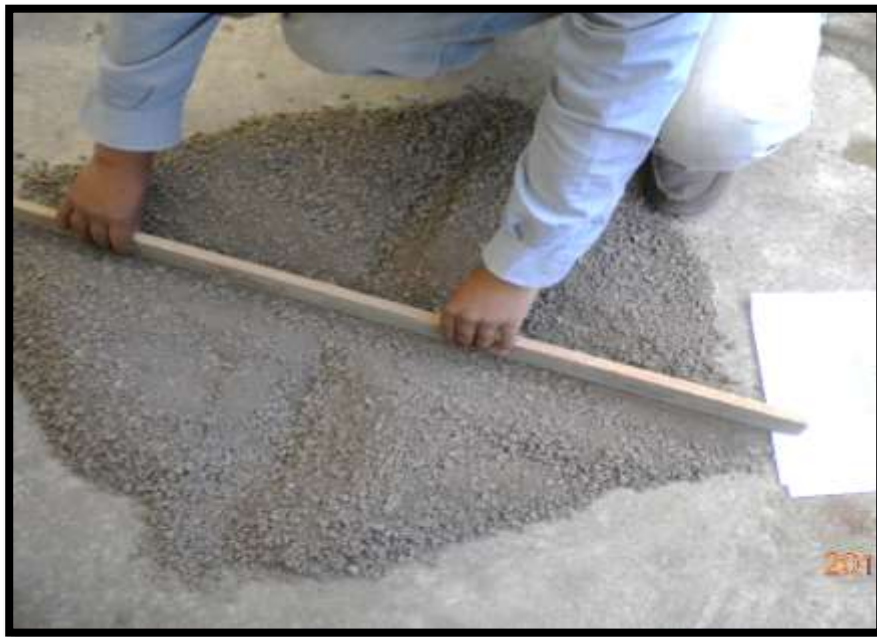
Figura 4 Cuarte del Agregado Fino Previo Al Ensayo De Granulometría
