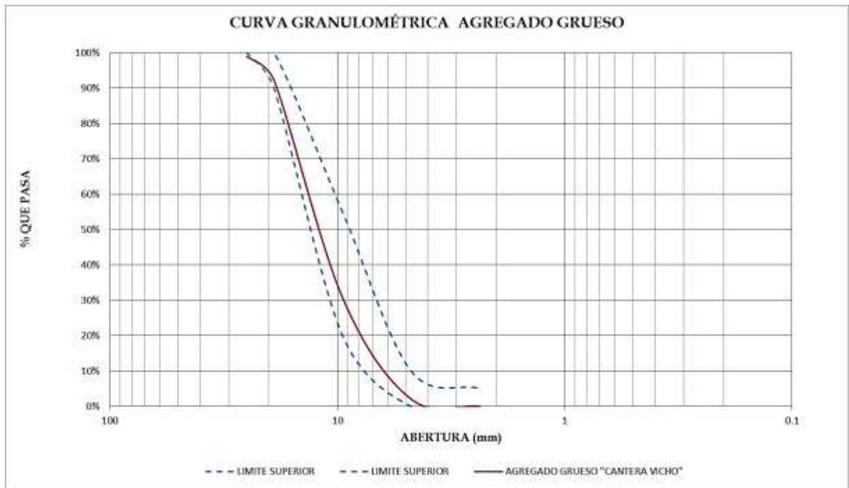
Figura 48 Curva Granulométrica Del Agregado Grueso
