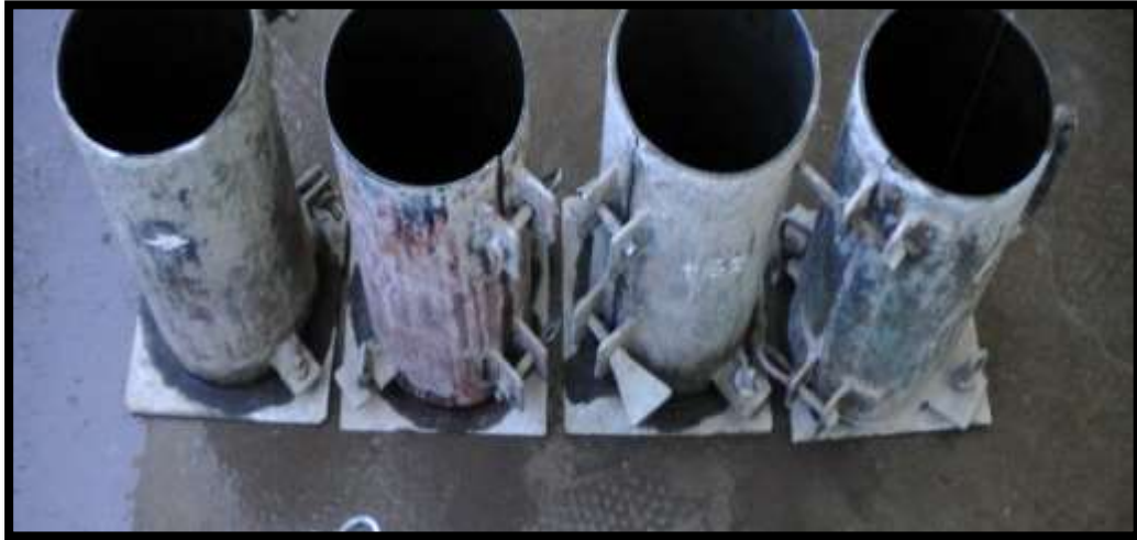
Figura 31 Briqueteras de Concreto Listas para el Vaciado
