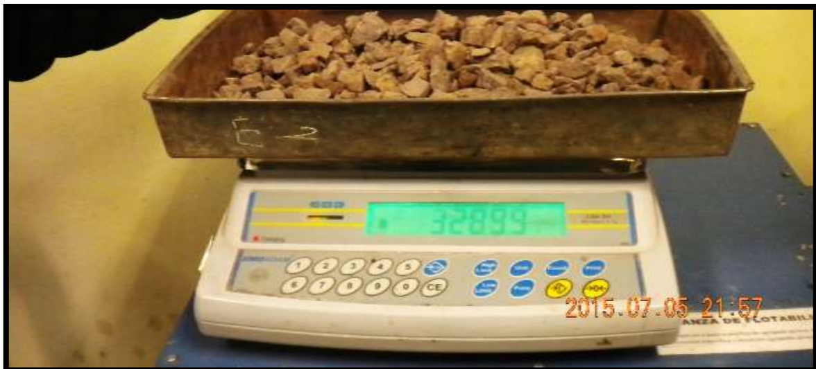
Figura 24 obtencion del peso del agregado compactado
