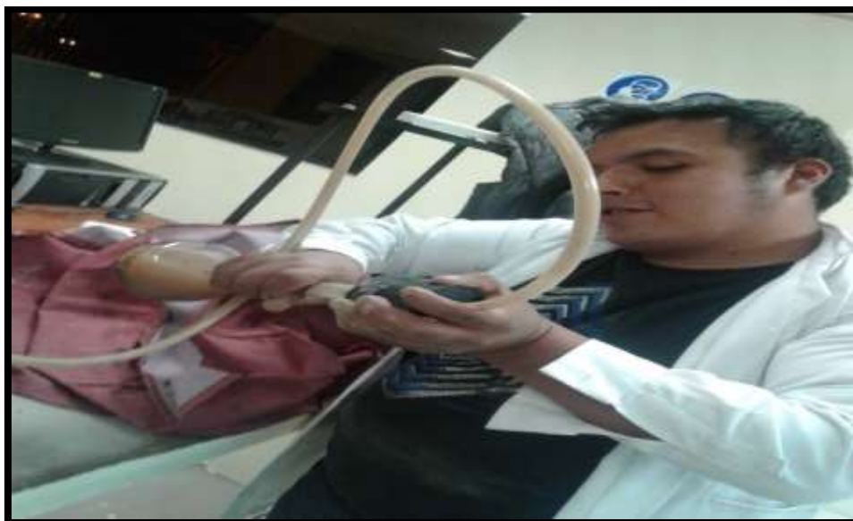
Figura 13 Eliminacion de Aire Mediante el Empleo de la Bomba de Vacios
