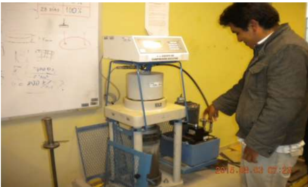
Figura 57. Rotura de briquetas de concreto
