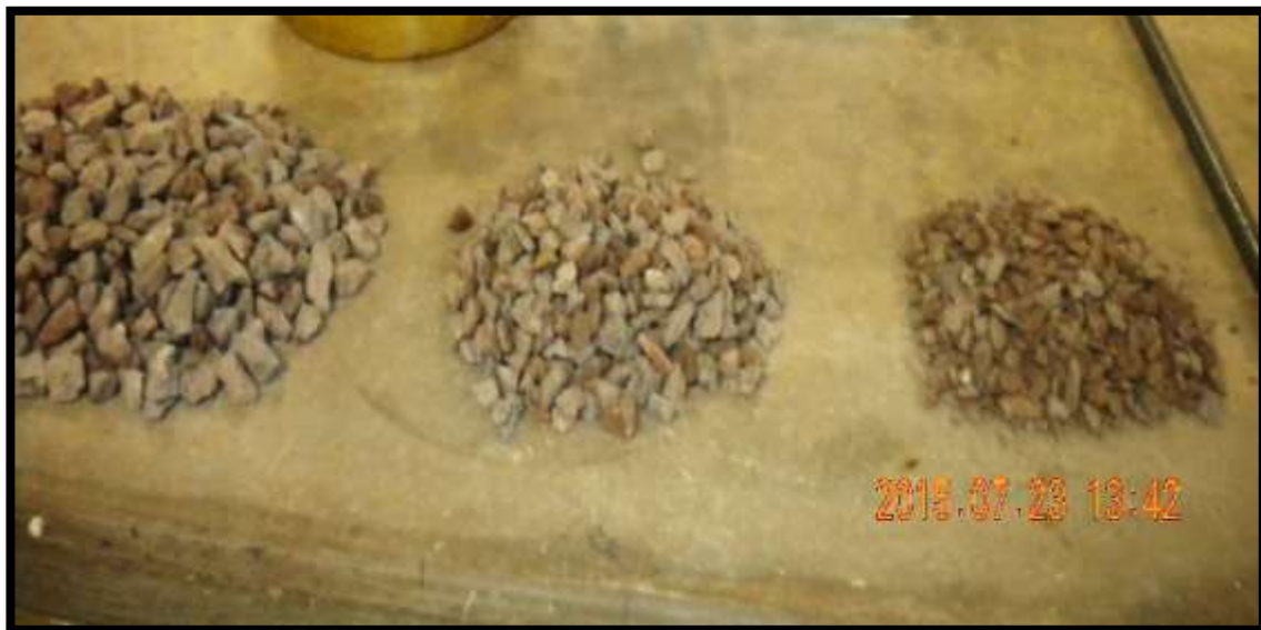
Figura 9 Gradacion del Agregado Grueso
