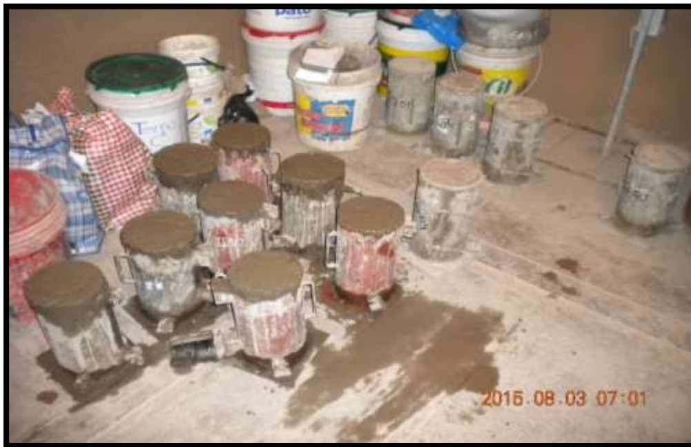
Figura 37 Testigos de Concreto Elaborados en Laboratorio de Suelos y Concretos
