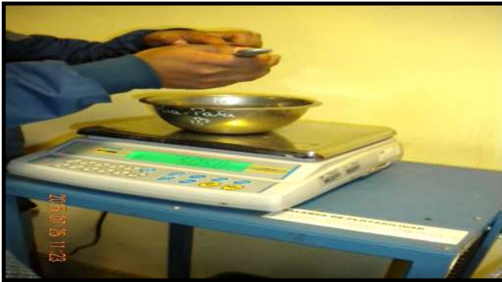
Figura 6 Obtencion del Peso de Agregado Fino Retenido en Cada Tamiz
