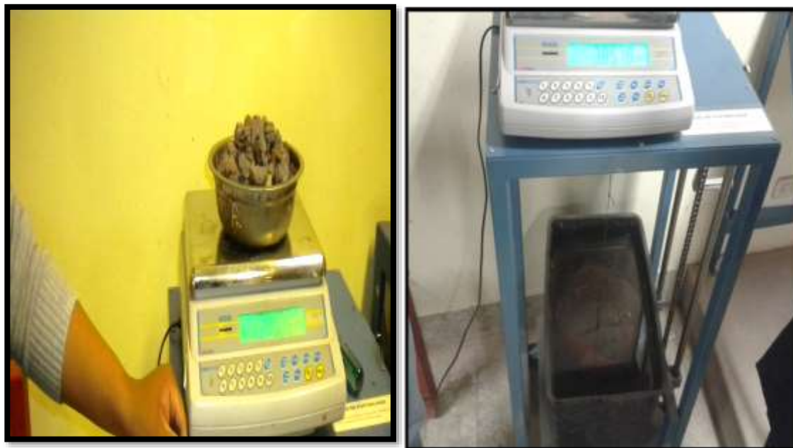
Figura 17 agregado superficialmente seco dentro de la cesta
