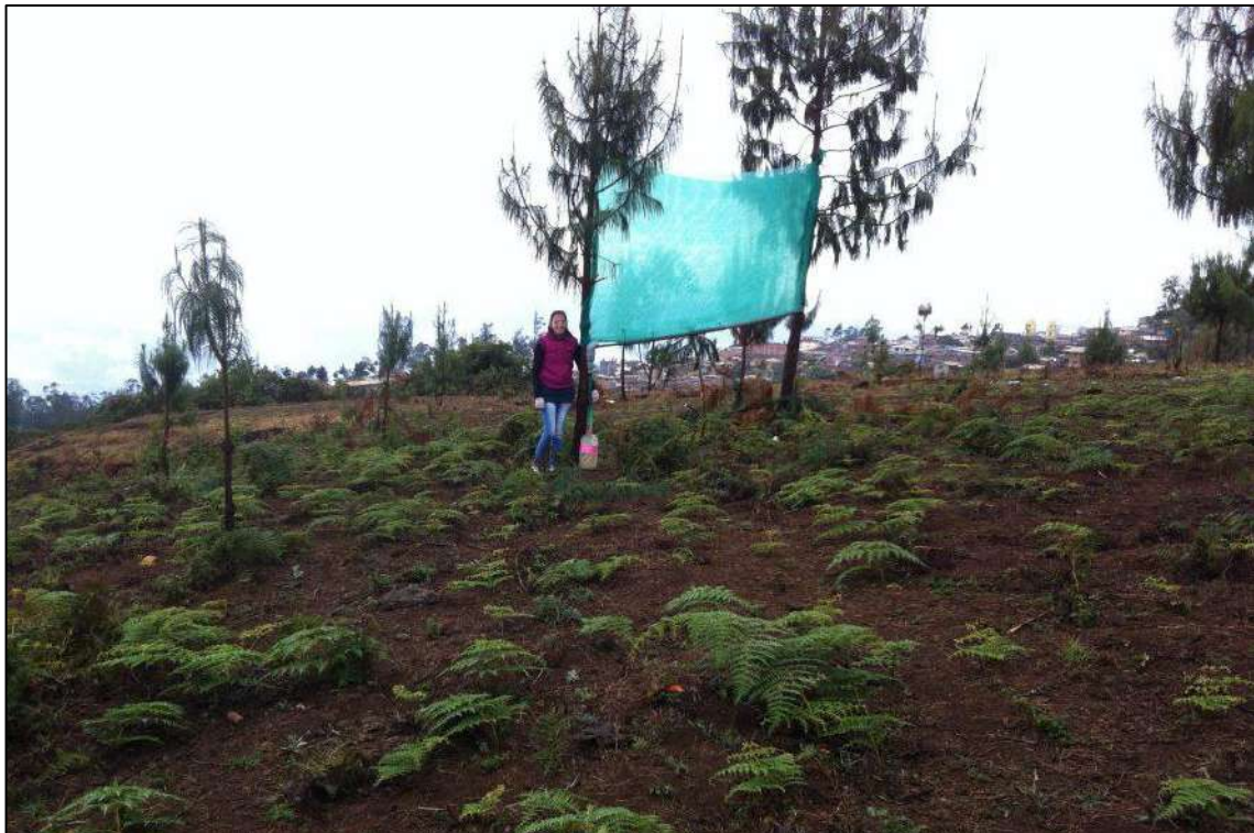
Captador de Neblina instalado y en funcionamiento.
