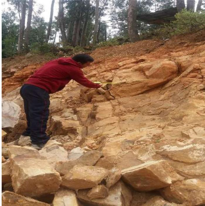
En esta estación estructural las rocas son básicamente areniscosas, cuarzosas, de coloración gris amarillenta a gris anaranjadas. Las fracturas son rectilíneas cuyas longitudes van en un orden de 6 a 19 metros. La consistencia de estas rocas es dura. Las fracturas poseen aberturas de 2 a 3 cm y se observan dispuestas en tres a más familias.
