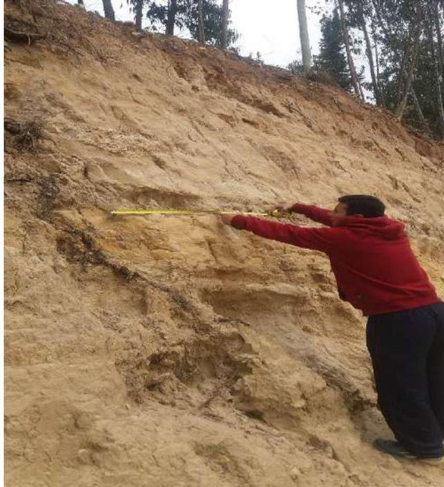
Esta estación se ubica en afloramientos de areniscas cuarzosas de grano medio a fino de coloración gris blanquecina, gris amarillentas y gris rojizo por la intensa oxidación de algunos minerales ferromagnesianos. Las fracturas poseen ángulos de buzamientos que van de  $40^{\circ}$  a  $60^{\circ}$ .
