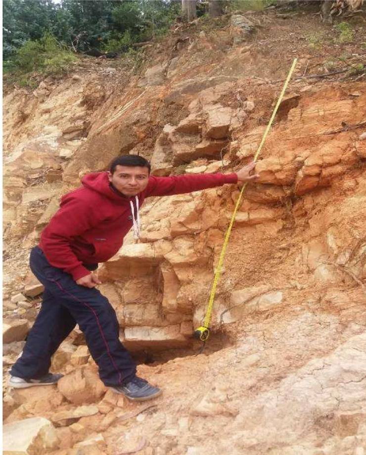
Se encuentran rocas areniscosas con cemento silíceo, dispuestas en estratos delgados y paralelos. Poseen una coloración gris rojiza por la meteorización. Existen también pequeños horizontes de limolitas y arcillitas de coloración gris rojizas. Las fracturas tienen dimensiones de 10 a 12 metros, en forma recta, espaciadas cada 8 cm. con aperturas de 2 a 3 cm.
