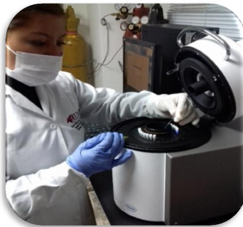
Figura 5. Muestras en el Termociclador para la amplificación de ADN
