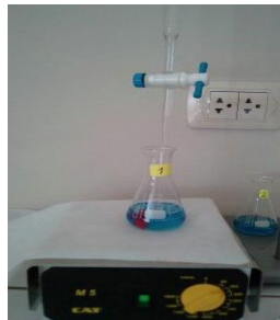
Figura 13. Titulación de la muestra con 0,05 M de HCl.
