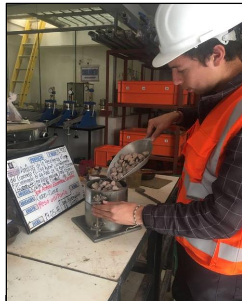
ENSAYO DE PESO UNITARIO SUELTO DEL AG. GRUESO
