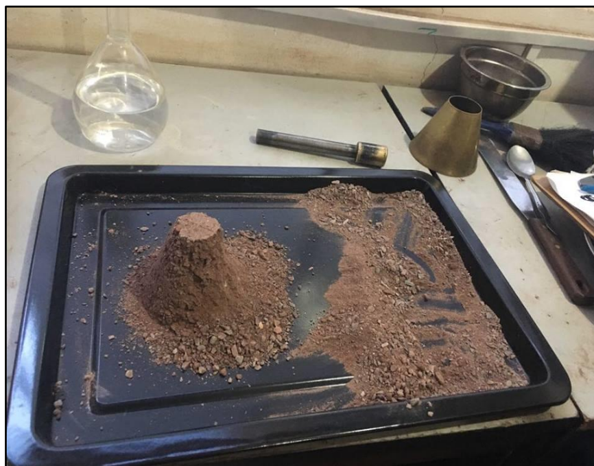
ENSAYO DEL CONO DE ABSORCIÓN CON EL AGREGADO FINO PROVENIENTE DE LA CANTERA CÓRDOVA (HUAMBUTTIO)
