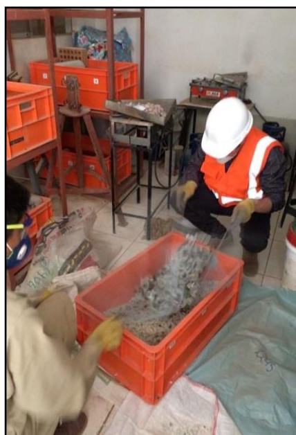
TAMIZADO EN LA MALLA 3/8", ANTES DE INGRESARLO A LA MÁQUINA DE ABRASIÓN
