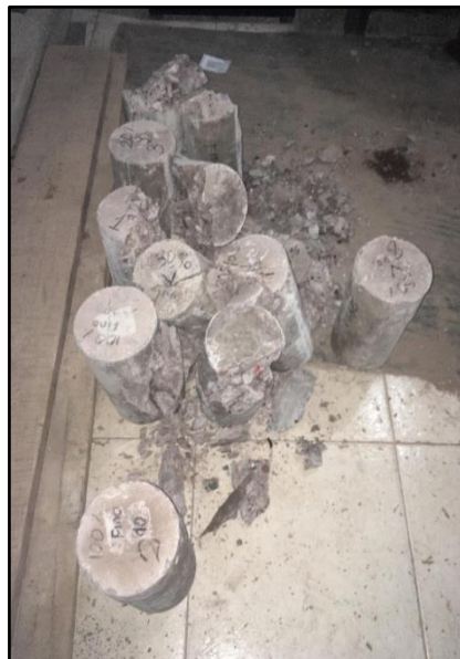
ENSAYO DE COMPRESION – PROCESO DE ROTURA DE BRIQUETAS
