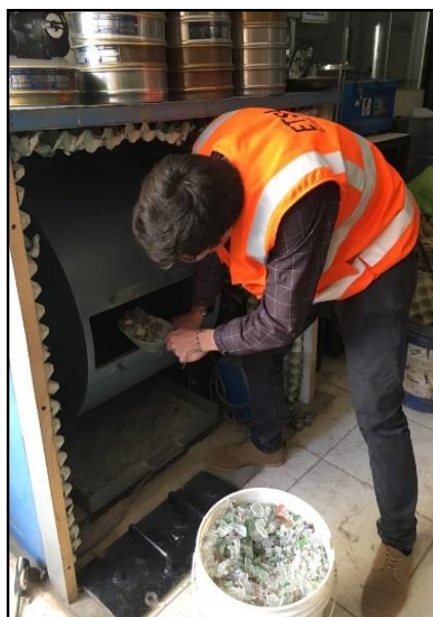
EXTRACCIÓN DE MATERIAL YA TRITURADO EN LA MÁQUINA DE ABRASIÓN
