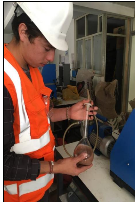
ENSAYO DEL PESO ESPECÍFICO DEL AGREGADO FINO Y VIDRIO MOLIDO CON LA BOMBA DE VACÍOS Y LA FIOLA
