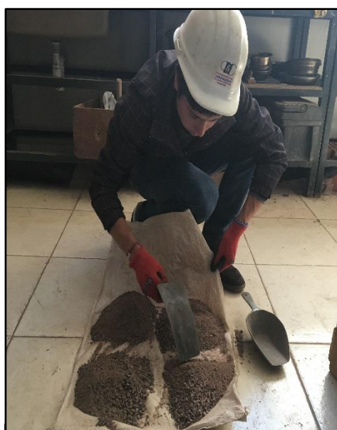
MUESTREO DEL AGREGADO FINO
