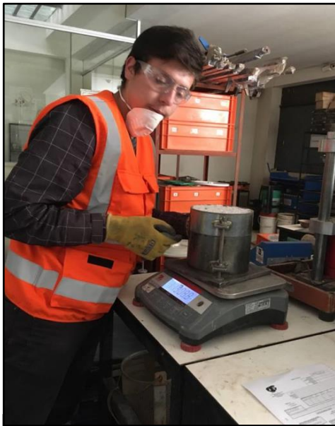
ENSAYO DE PESO UNITARIO SUELTO DEL AG. FINO
