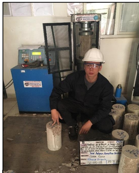
PROCESO DE ROTURA DE BROQUETAS
