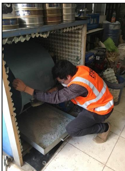
INTRODUCCIÓN DE VIDRIO MOLIDO EN FASE 1 Y TAMIZADO EN LA MALLA 3/8 "A MÁQUINA DE ABRASIÓN
