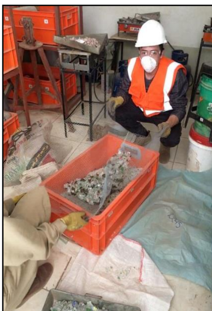
TAMIZADO EN LA MALLA 3/8", ANTES DE INGRESARLO A LA MÁQUINA DE ABRASIÓN
