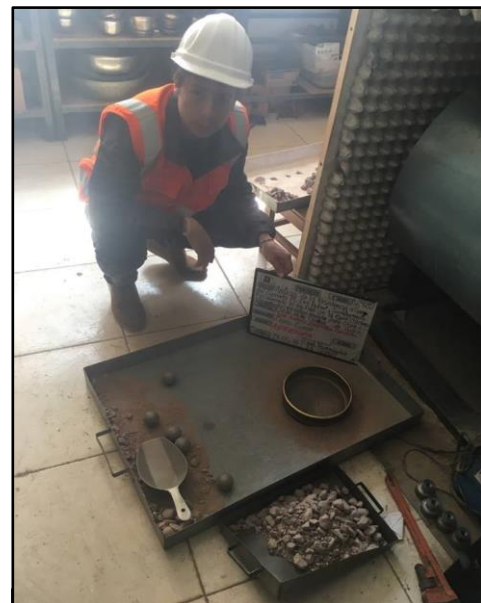
DESGASTE POR ABRASION EN LA MAQUINA DE LOS
