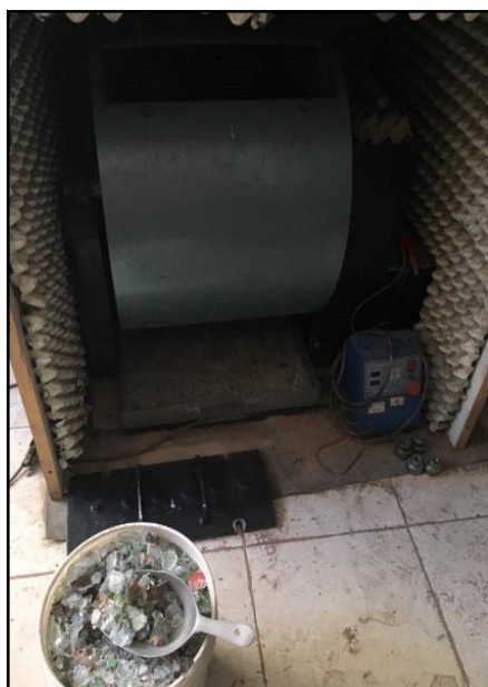
EXTRACCIÓN DE MATERIAL YA TRITURADO EN LA MÁQUINA DE ABRASIÓN
