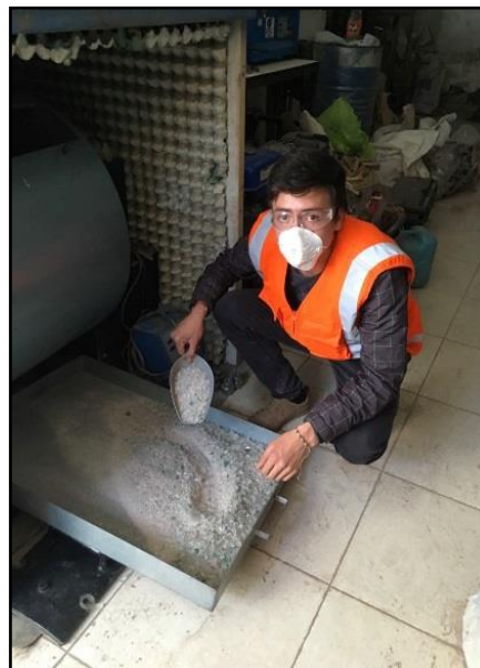
INTRODUCCIÓN DE VIDRIO MOLIDO EN FASE 1 Y TAMIZADO EN LA MALLA 3/8 "A MÁQUINA DE ABRASIÓN
