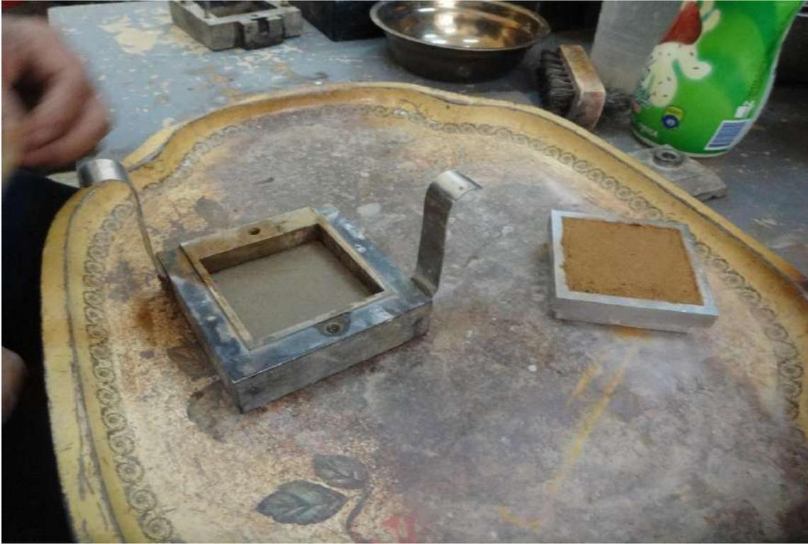
**Figura 251.** Colocando la muestra en el molde.
