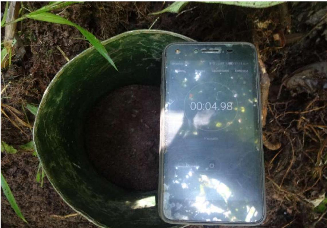
**Figura 232.** Prueba de infiltración sin vegetación en sector de Platanillo de Shimaki.
