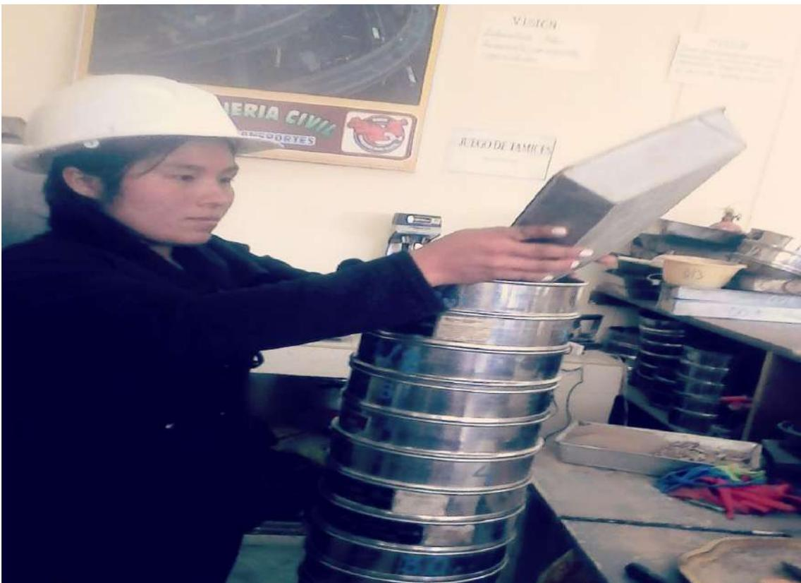
**Figura 246.** Ensayo granulométrico mediante el tamizado.
