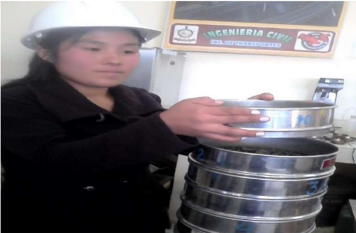
**Figura 247.** Tamizado de los materiales extraídos de todas las calicatas.
