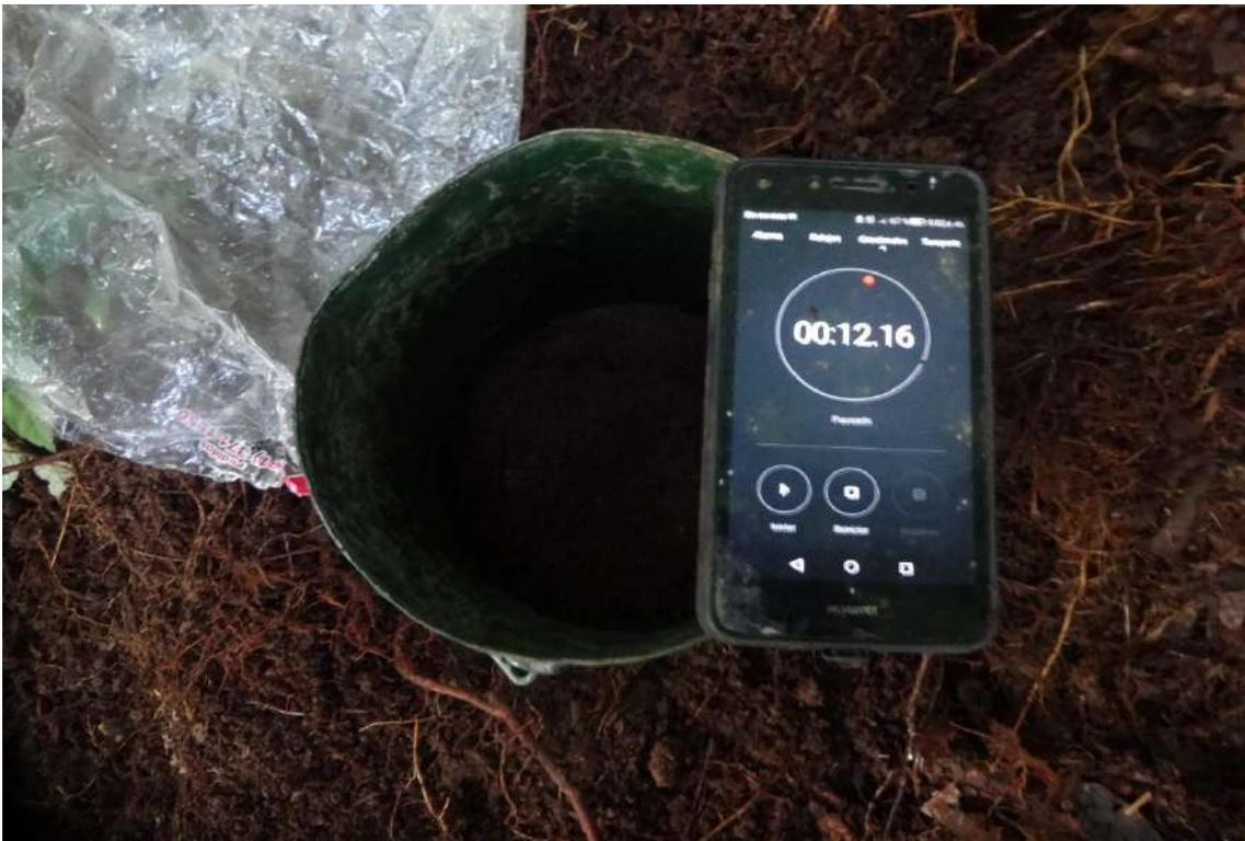
**Figura 230.** Prueba de infiltración sin vegetación en el sector Acolla.
