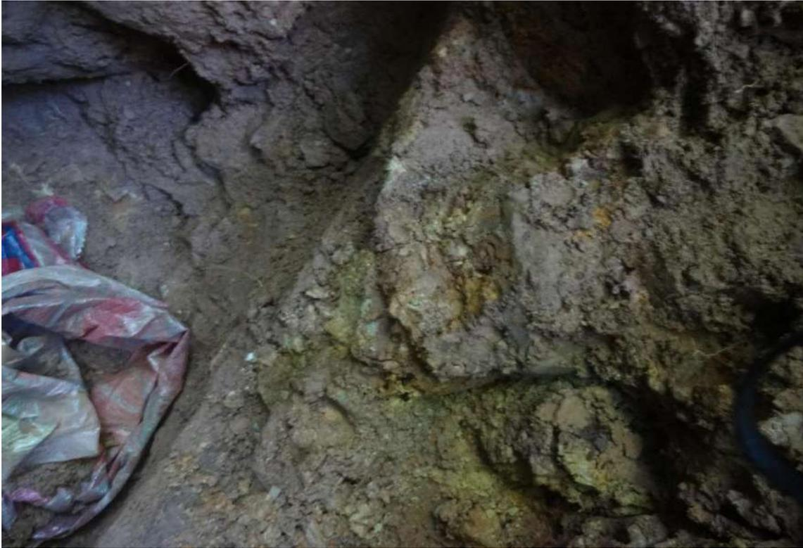
**Figura 227.** Extracción de muestra a 1.20 m de profundidad debido a que el resto es material rocoso en la calicata n°3 en el sector Miritiriani.
