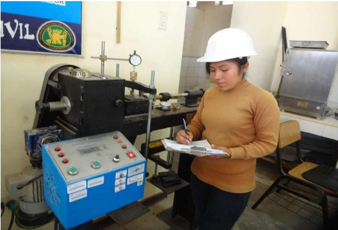
**Figura 252.** Tomando lectura de los deformímetros en el ensayo de corte directo.
