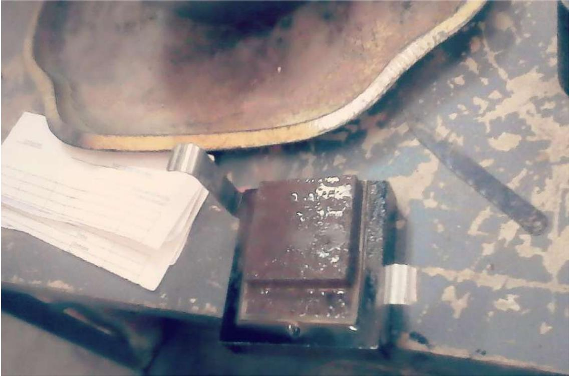
**Figura 253.** Desmoldando la muestra del ensayo de corte directo.
