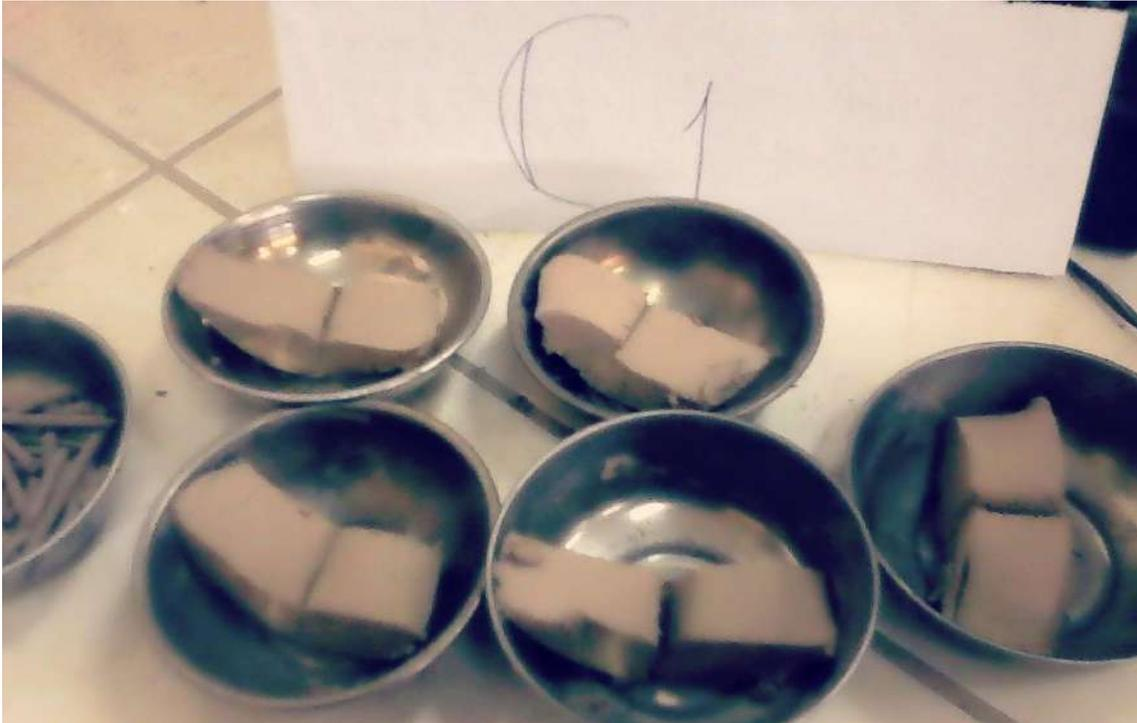
**Figura 255.** Muestras secas de los ensayos de límite líquido y plástico de la calicata n°1.
