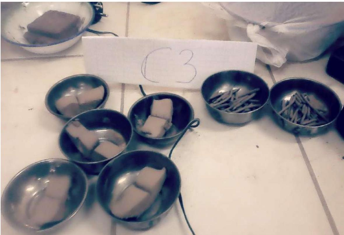
**Figura 256.** Muestras secas de los ensayos de límite líquido y plástico de la calicata n°3.
