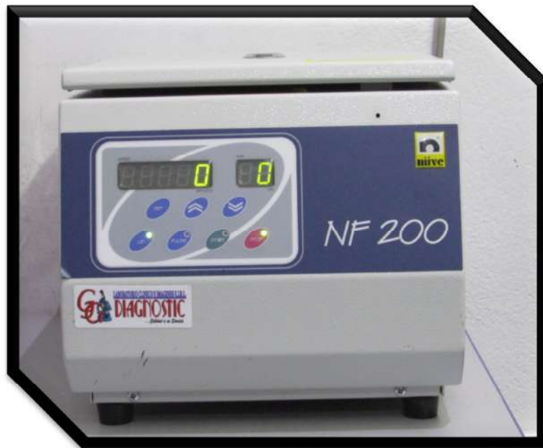
Fig. 4. Centrifuga clínica de mesa para 12 tubos de 15 ml modelo Nf 200.
