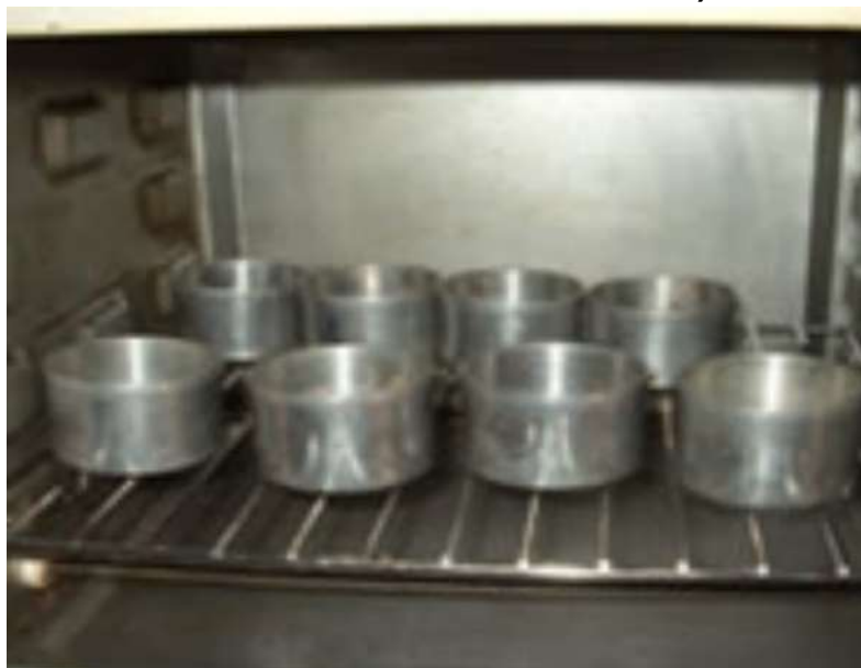
Figura 06 Taras Colocados en el Horno (Ensayo de contenido de concluido de Humedal)
