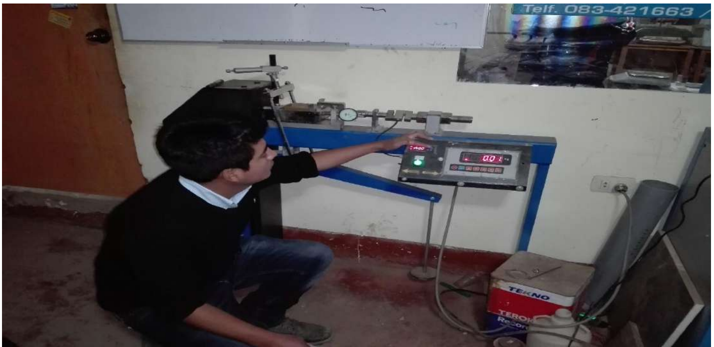
Fotografía N a 17: vista del ensayo de corte directo
