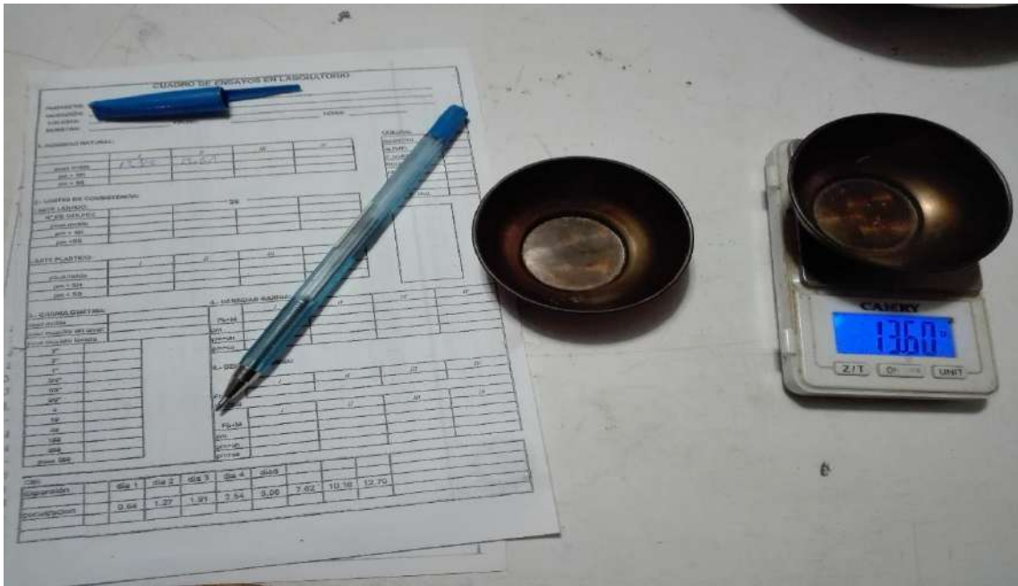
Fotografía N a 7: Pesaje de capsulas para ensayo contenido de humedad
