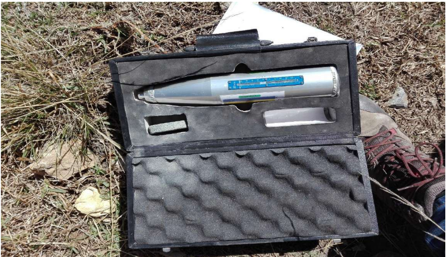
Fotografía N o 28: Vista del ensayo de resistencia a la compresión “esclerometria”
