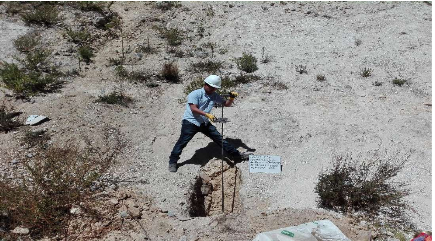
Fotografía Nª 20: Vista del ensayo de (DPL)
