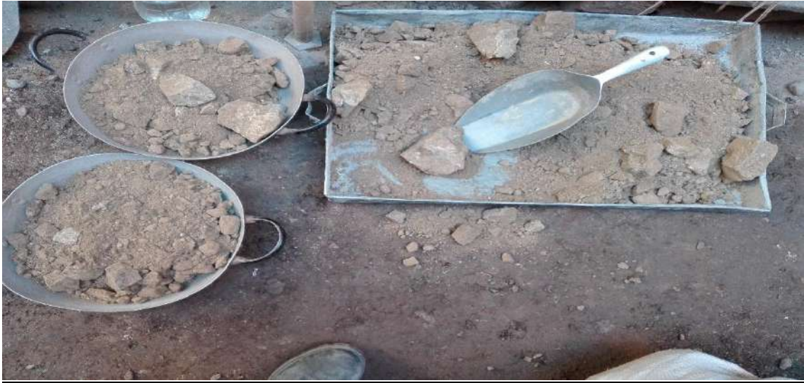
Fotografía N o 5: Cuarteo de la muestra para los diferentes ensayos
