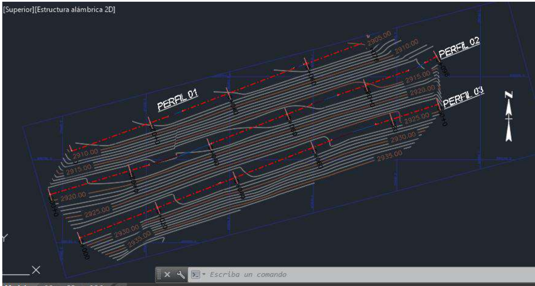
Figura 21: Perfil longitudinal de las banquetas
