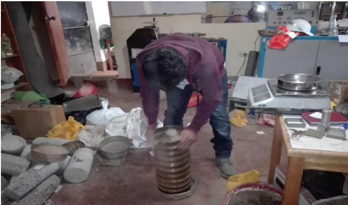
Fotografía N o 12: vista el ensayo de granulometría por tamizado
