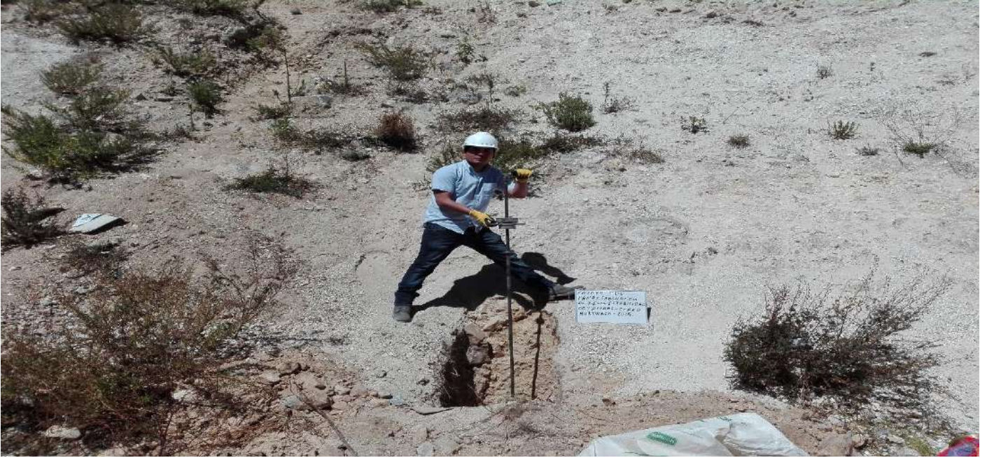
Fotografía Nª 19: vista del ensayo de (DPL)
