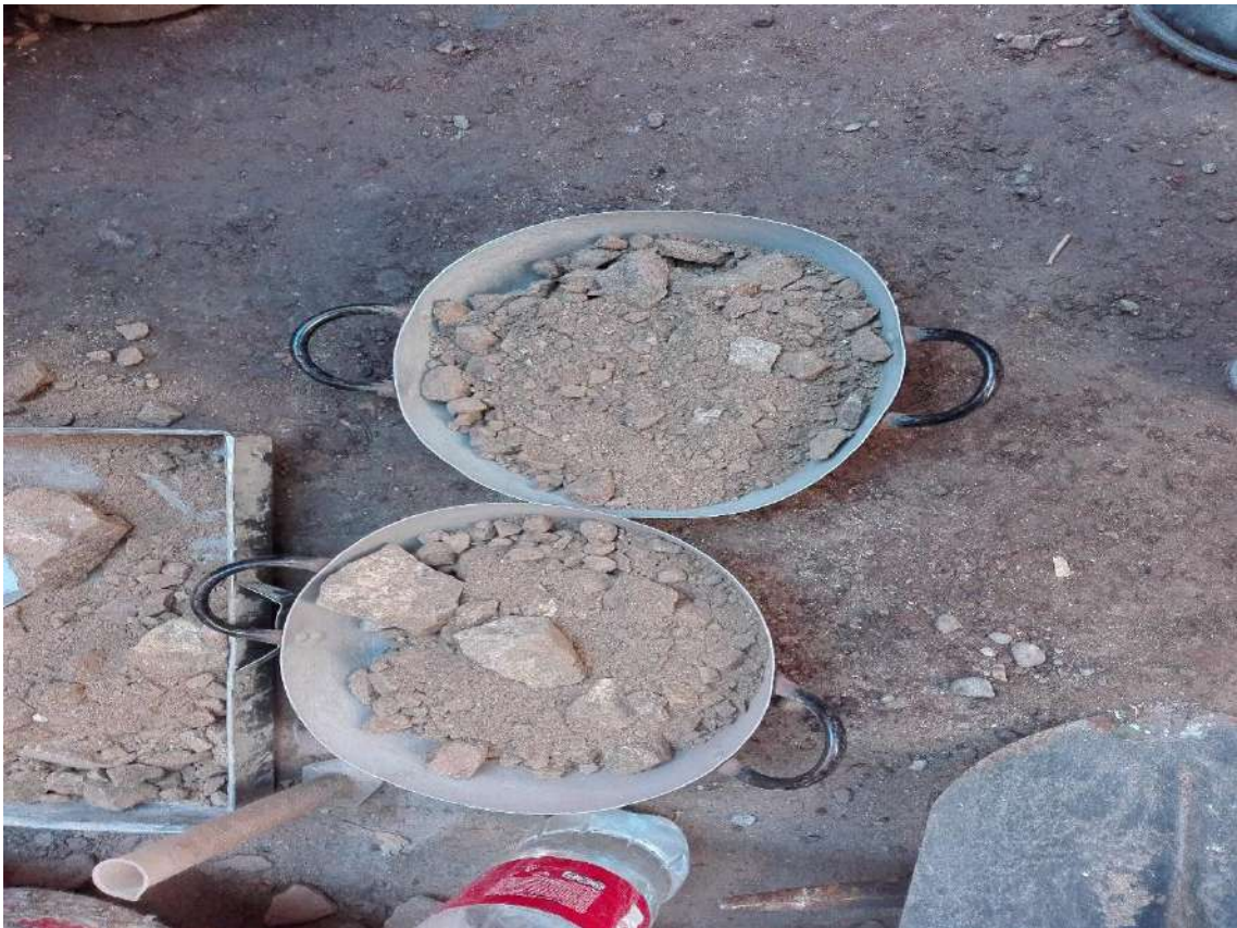
Fotografía N o 6: Cuarteo de la muestra para los diferentes ensayos
