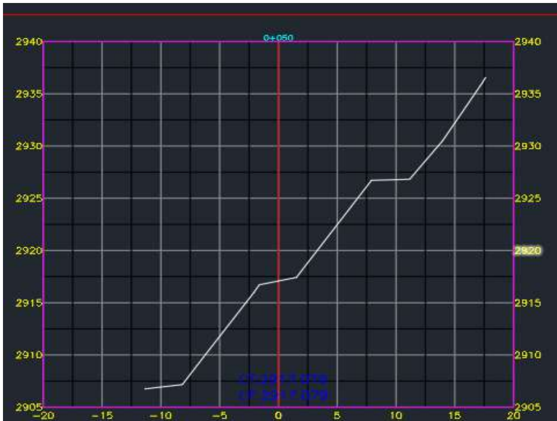
Figura 29: Sección 0+050 del talud del cerro Huayhuaca
