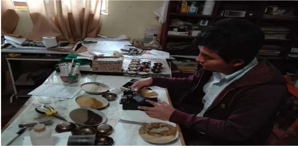
Fotografía Nª 9: vista el ensayo de límites de consistencia “límite plástico”
