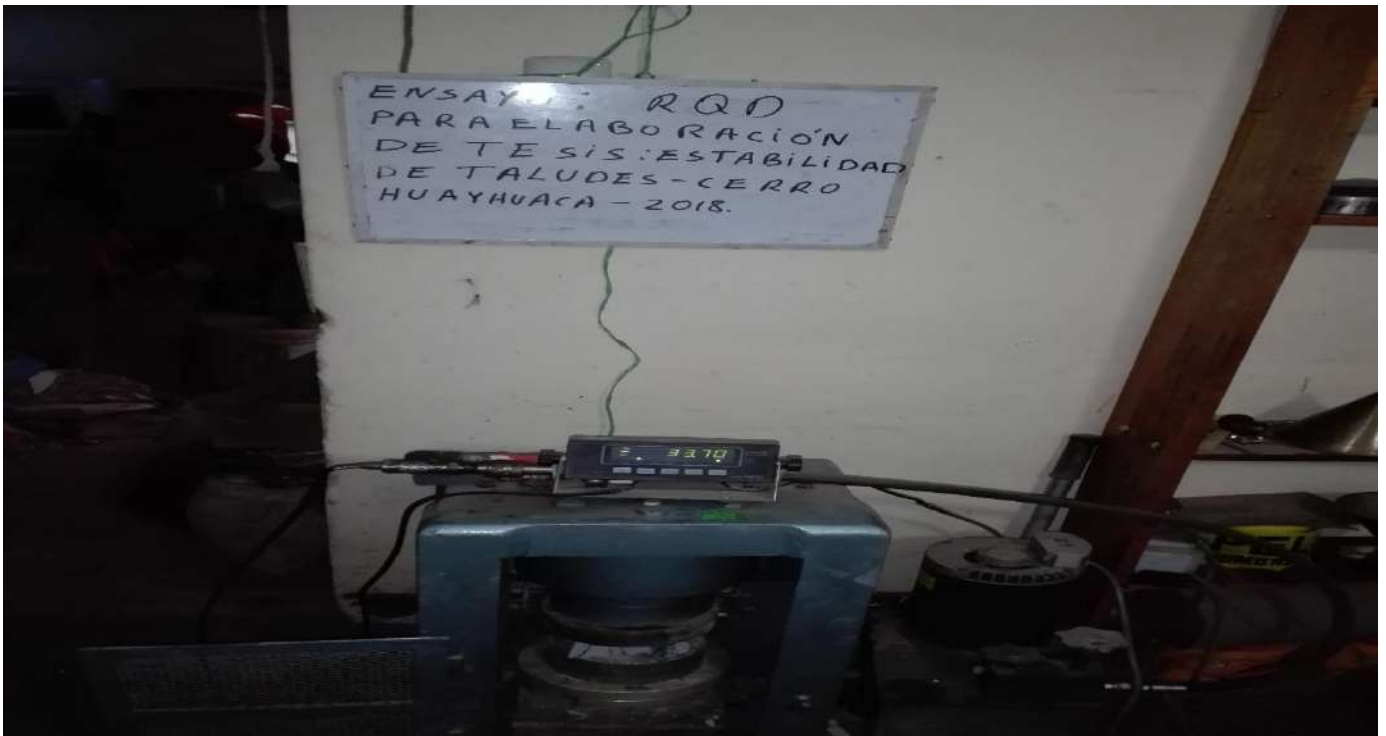
Fotografía N° 15: vista del ensayo de resistencia a la compresión de las rocas
