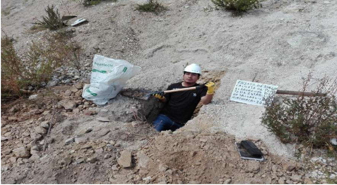
Fotografía Nª 3: Vista de la calicata C-1 extracción de muestra de suelos
