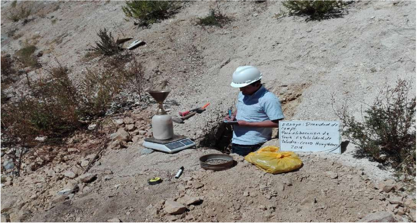
Fotografía Nª 21: Vista del ensayo de densidad de campo
