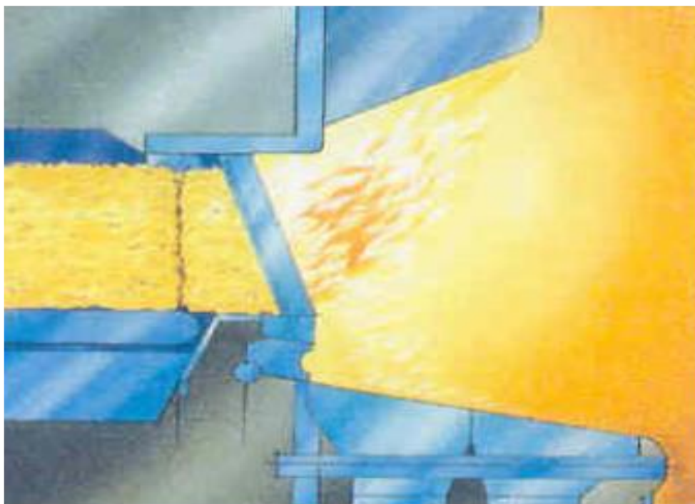
Figura N° 21: Esquema de caldera con tecnología cigar firing.
