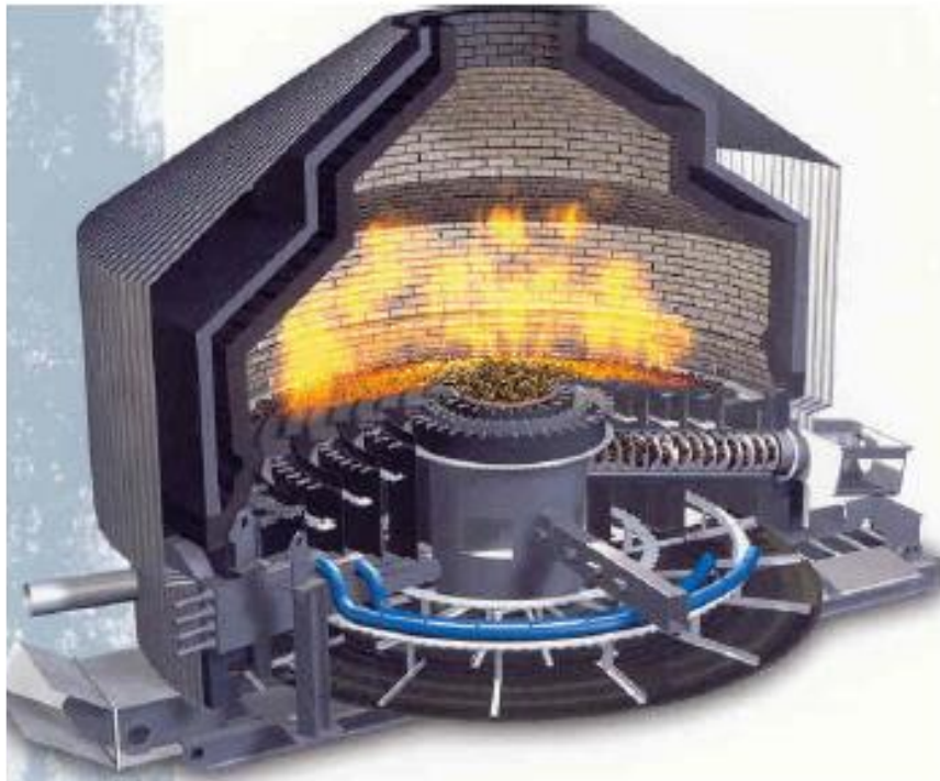
Figura N° 20: Esquema de una caldera de biomasa de a floración con parrilla giratoria.
