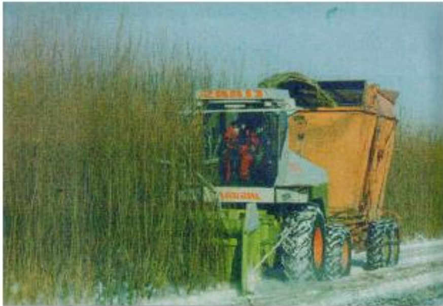
Figura N° 7: Cosecha de biomasa de sauce en alta densidad y corta rotación
