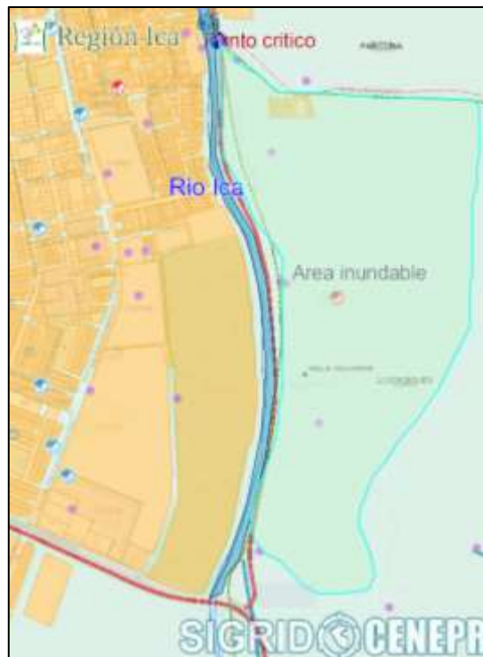
Figura 2.69: Redes viales, Pozos y predios urbanos ubicados dentro del área celeste con la probabilidad de inundación por el desborde del Río Ica.
