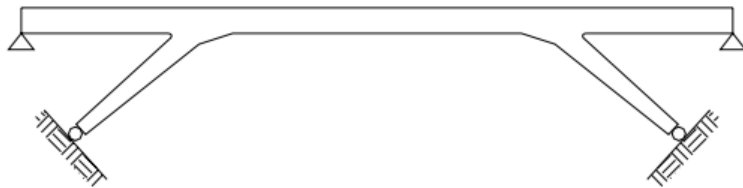
Figura 4.23. Puente Pórtico tipo jabalconados Idealización.
