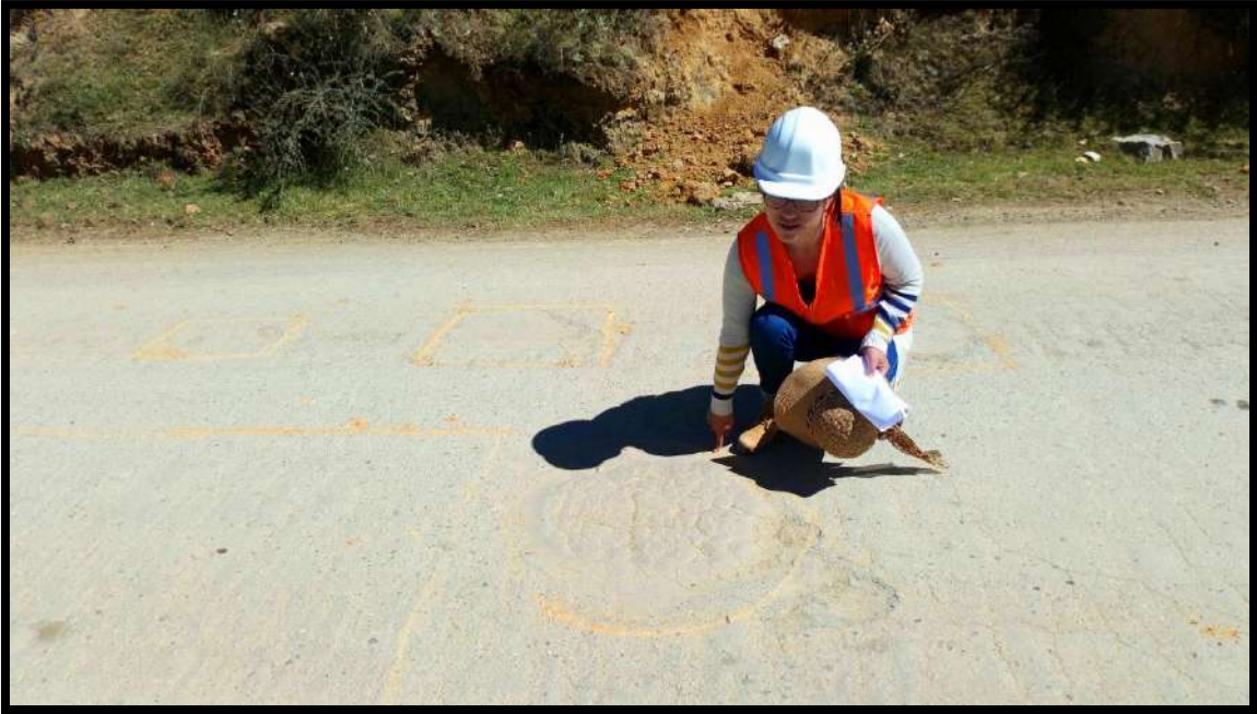
Anexo 1.7: Medición de áreas de cada falla
