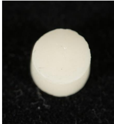
FIGURA N° 12 Muestra final de resinas compuestas nanohíbridas de 5mm de diámetro y 4mm de altura
