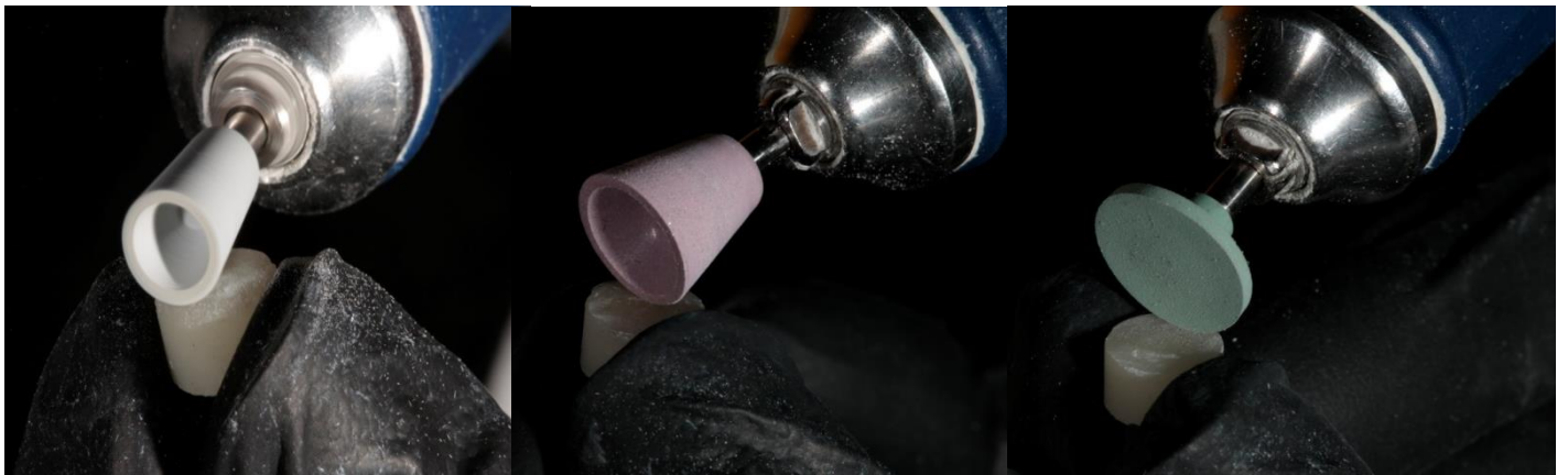
FIGURA N° 13 Pulido final de las muestras de resinas nanohíbridas polimerizadas con y sin gel hidrosoluble
