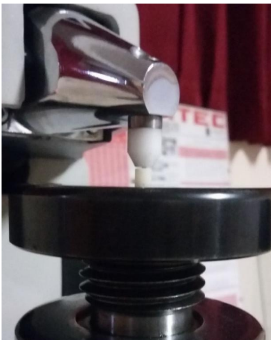
FIGURA N° 16 Profundidad de penetración con una bola de acero, sobre la muestra
