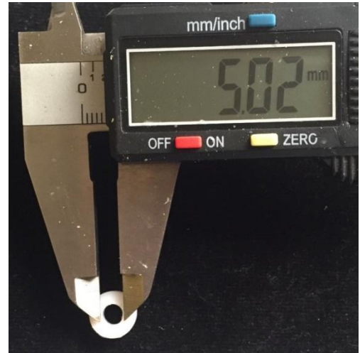
FIGURA N° 3 Calibración de la matriz el calibrador
