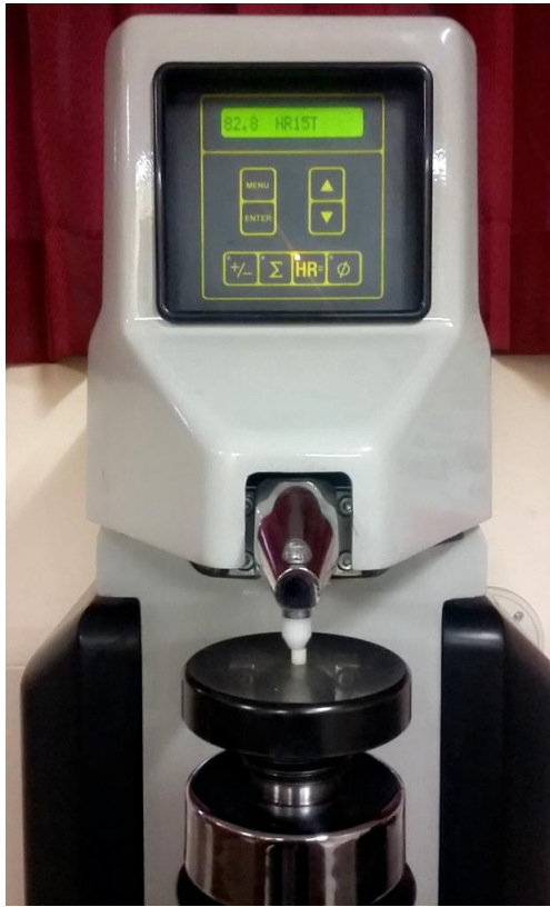
FIGURA N° 17 Realizamos con una carga de HR15T y lo convertimos a Newton/mm 2
