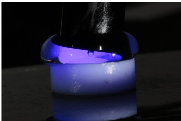
FIGURA N° 9 Aplicamos en la superficie el gel hidrosoluble
