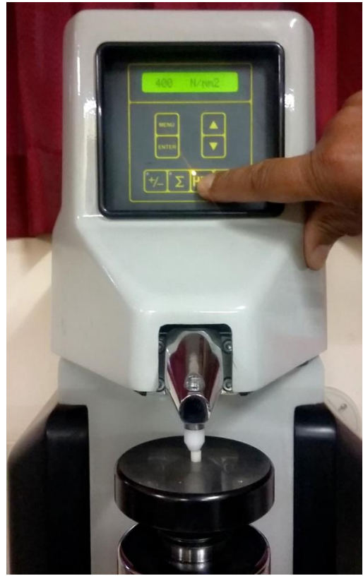
FIGURA N° 17 Realizamos con una carga de HR15T y lo convertimos a Newton/mm 2
