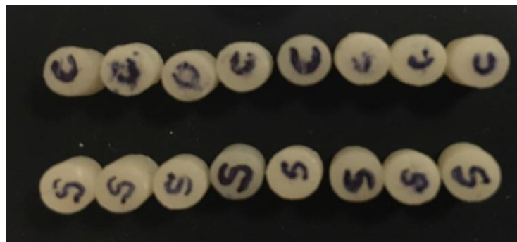
FIGURA N° 13 Pulido final de las muestras de resinas nanohíbridas polimerizadas con y sin gel hidrosoluble
