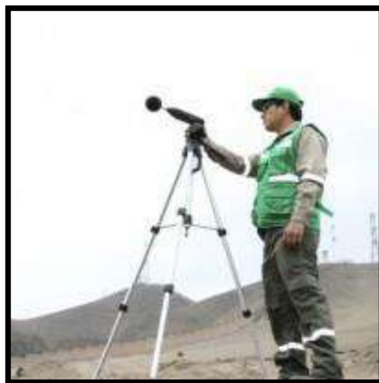
FIGURA N° 01: Monitoreo de la calidad del ruido en área desértica
