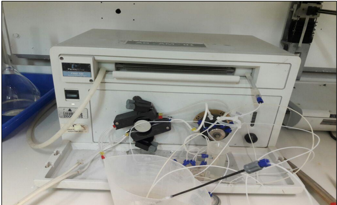
Figura 25: Muestreo con ICP del agua de drenaje ácido.
