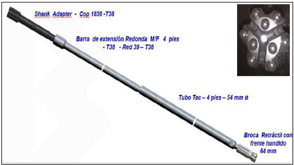
Figura 3. Taladros largos para perforación
