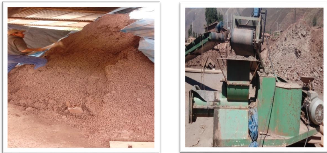
Figura 23 Trituración y amasado con maquinaria artesanal.
