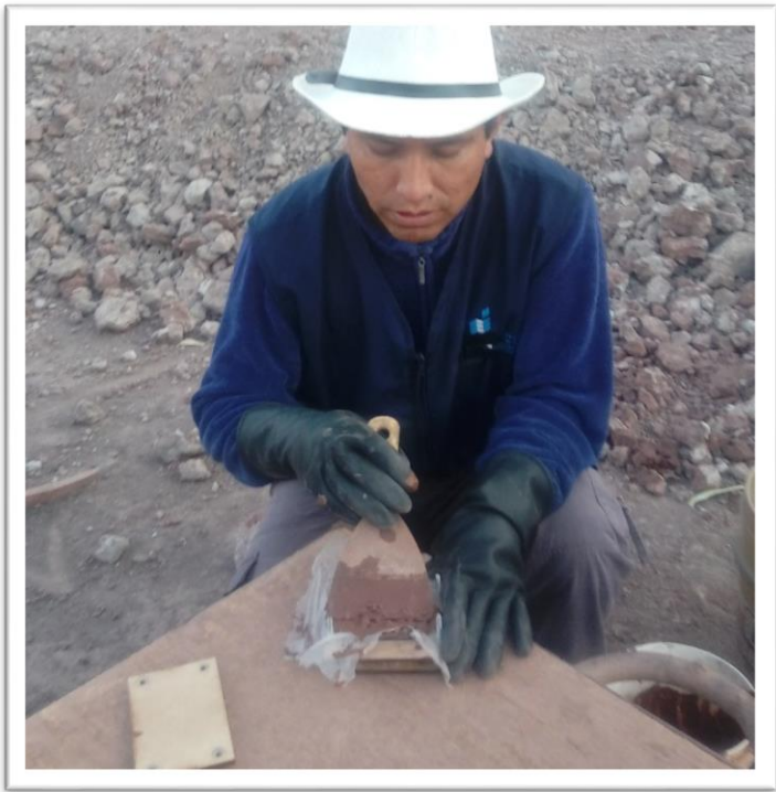
FOTO N° 10: LLENADO DE LA CELDA DE MEDICIONES CON ARCILLA HUMEDA.
