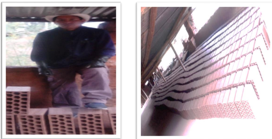
Figura 8: Secaderos al aire libre con cubierta. Proceso de secado de ladrillos tipo bloker.
