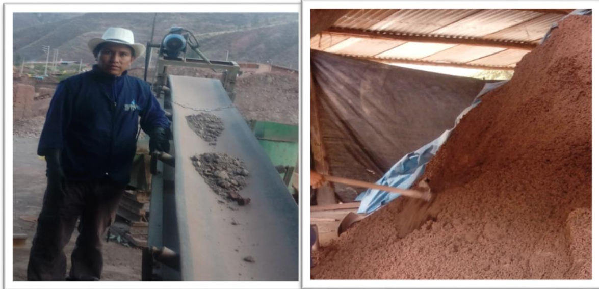
Figura 22 Maduración, amasado de la arcilla para la producción de ladrillos
