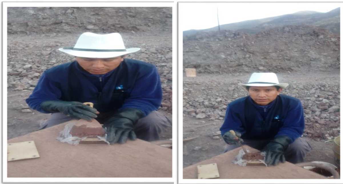
Figura 8 Muestra compactada en la celda de medición.
