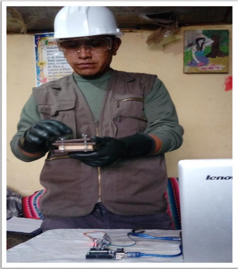
FOTO N° 12: INSERCIÓN DEL SENSOR DE HUMEDAD EN LA CELDA.
