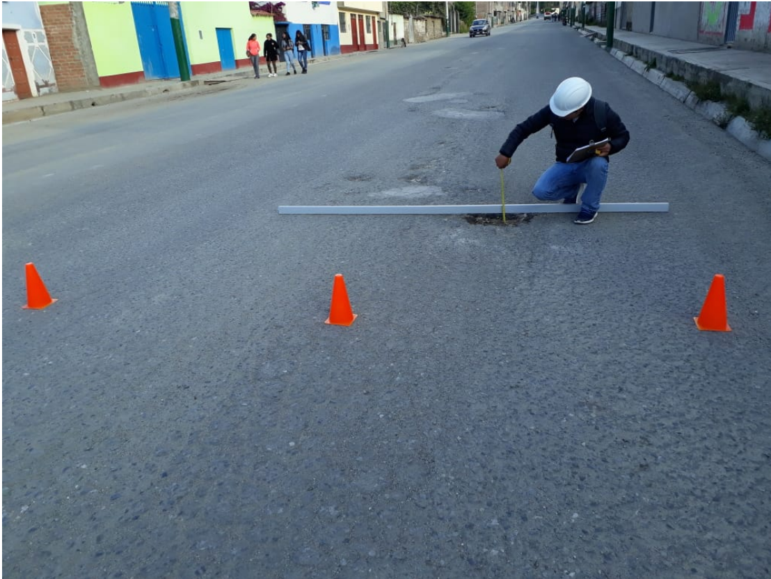
Fotografía 7: Se aprecia en la imagen midiendo la profundidad del ojo de pescado.
