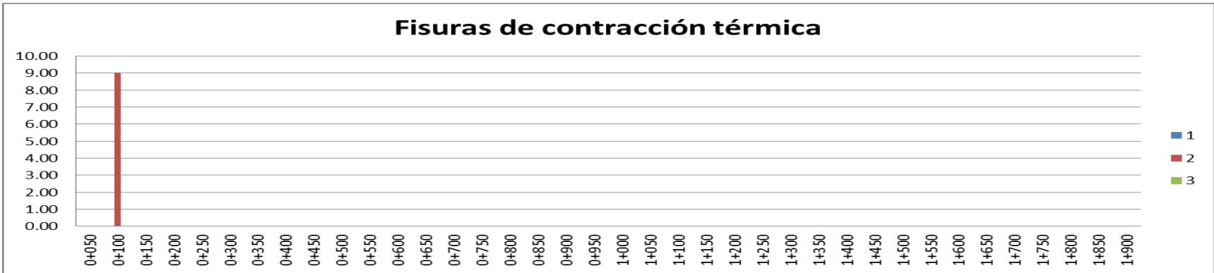
Figura 36: Distribución de deterioro del tipo B – Fisuras de contracción térmica (Progresiva 0+000 – 1+900)
