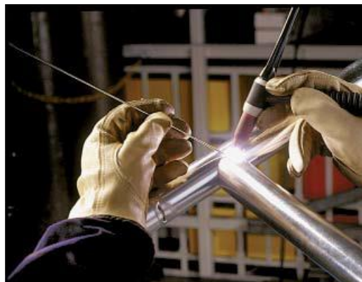
Figura 6. Soldadura con Proceso GTAW.
