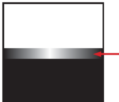
Figura 5. Restauración por Ralladura del Acero Inoxidable.
