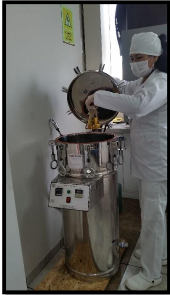
Fig.14. Podemos observar la esterilización del agar Miuller Hinton en 15 minutos, a una presión de 15 libras, a una temperatura de 121°.
