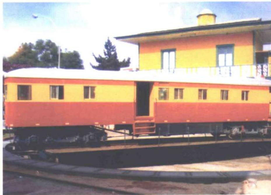
**Tornamesa:** Que sirve para hacer girar las máquinas o cambiar el sentido de la vía, lo cual fue expresamente diseñada para dicha estación, existiendo desde sus inicios.
