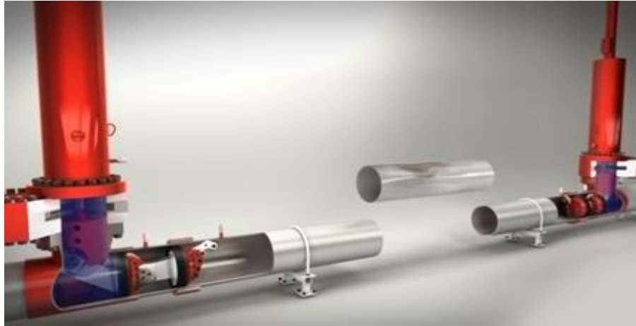
Figura 12 Cabeza Obturadora Instalada
