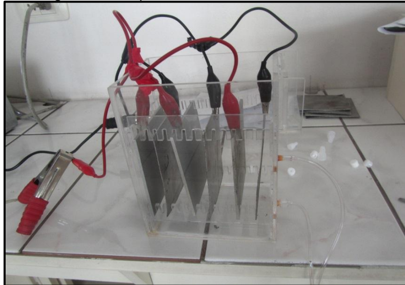
Figura 3.6. Disposición de los electrodos en la celda
