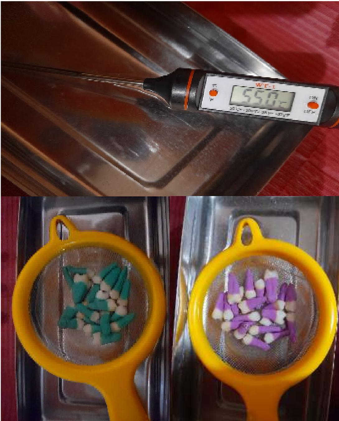
Fig.12. Termociclado manual de 55°C.
