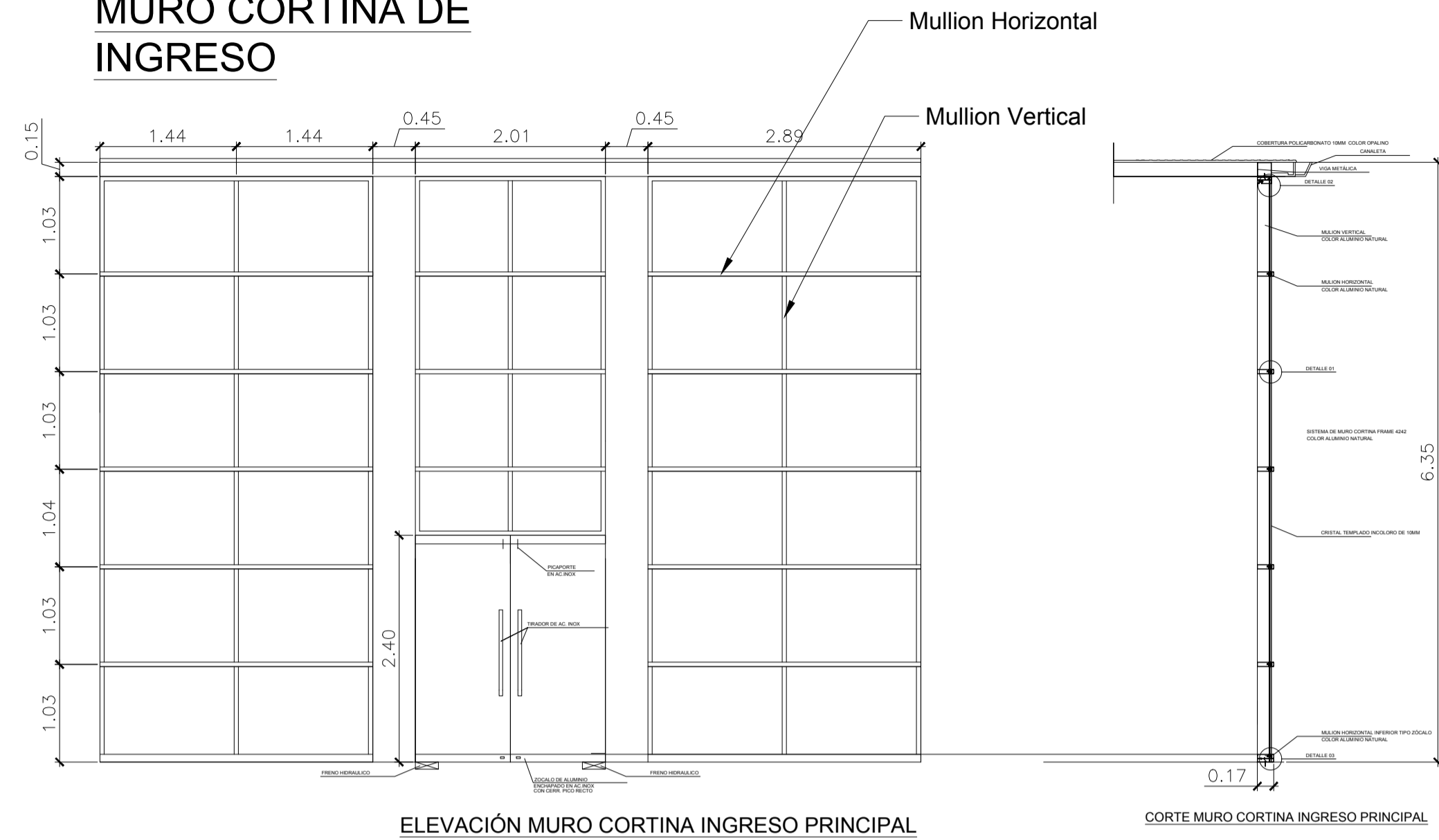
ELEVACIÓN MURO CORTINA INGRESO PRINCIPAL
