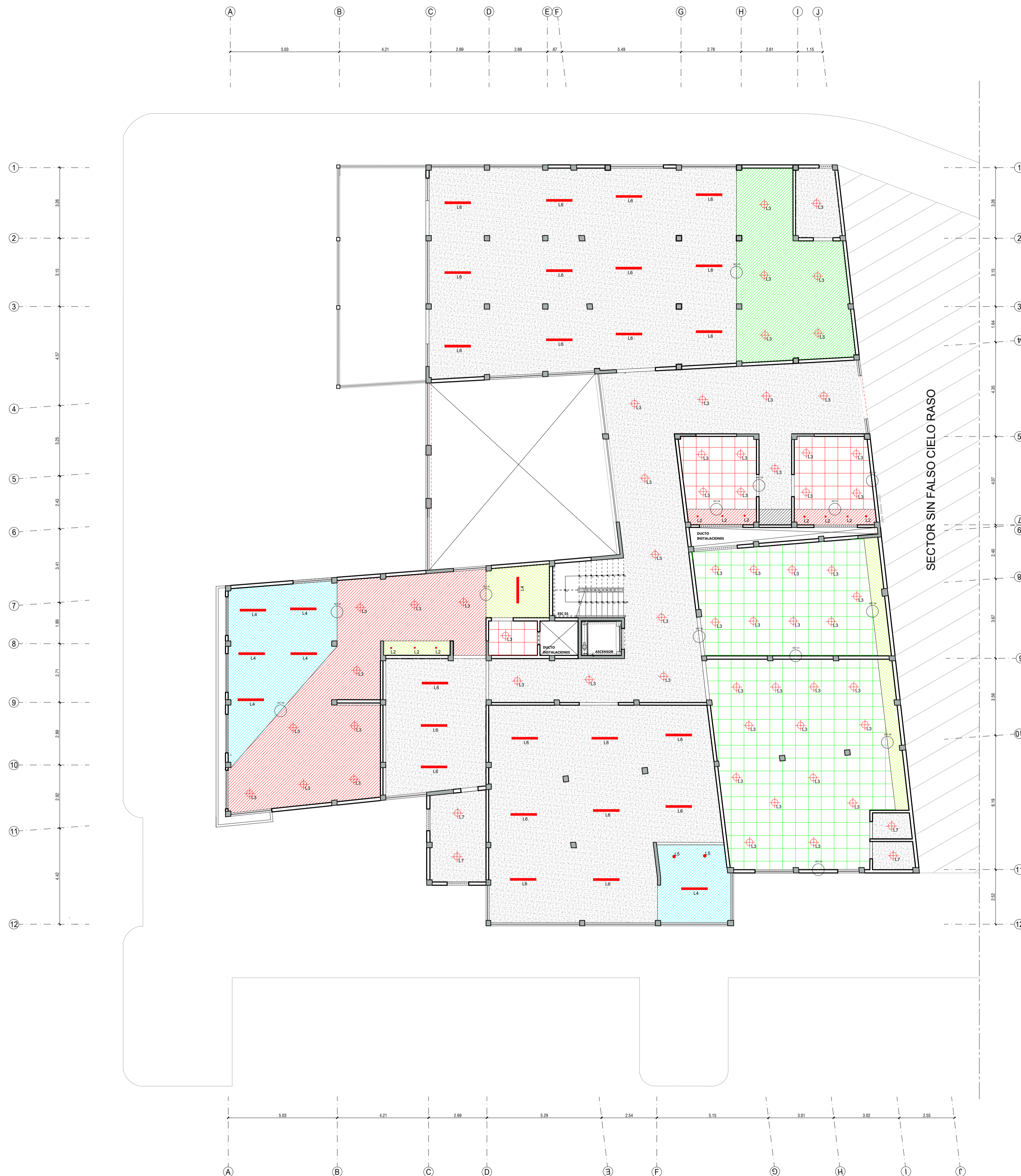
Planta Falso Cielo Raso Segundo Piso escala 1/75
