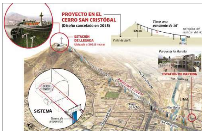
Fig. 34 Propuesta de la Municipalidad de Lima. Teleférico Cerro san Cristóbal - Centro de Lima
