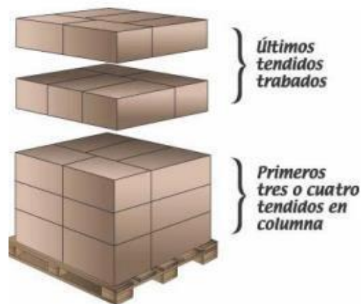
Figura 17. Primer método estiba de pallet
