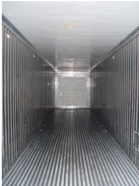
Figura 11 Vista interna del contenedor refrigerado
