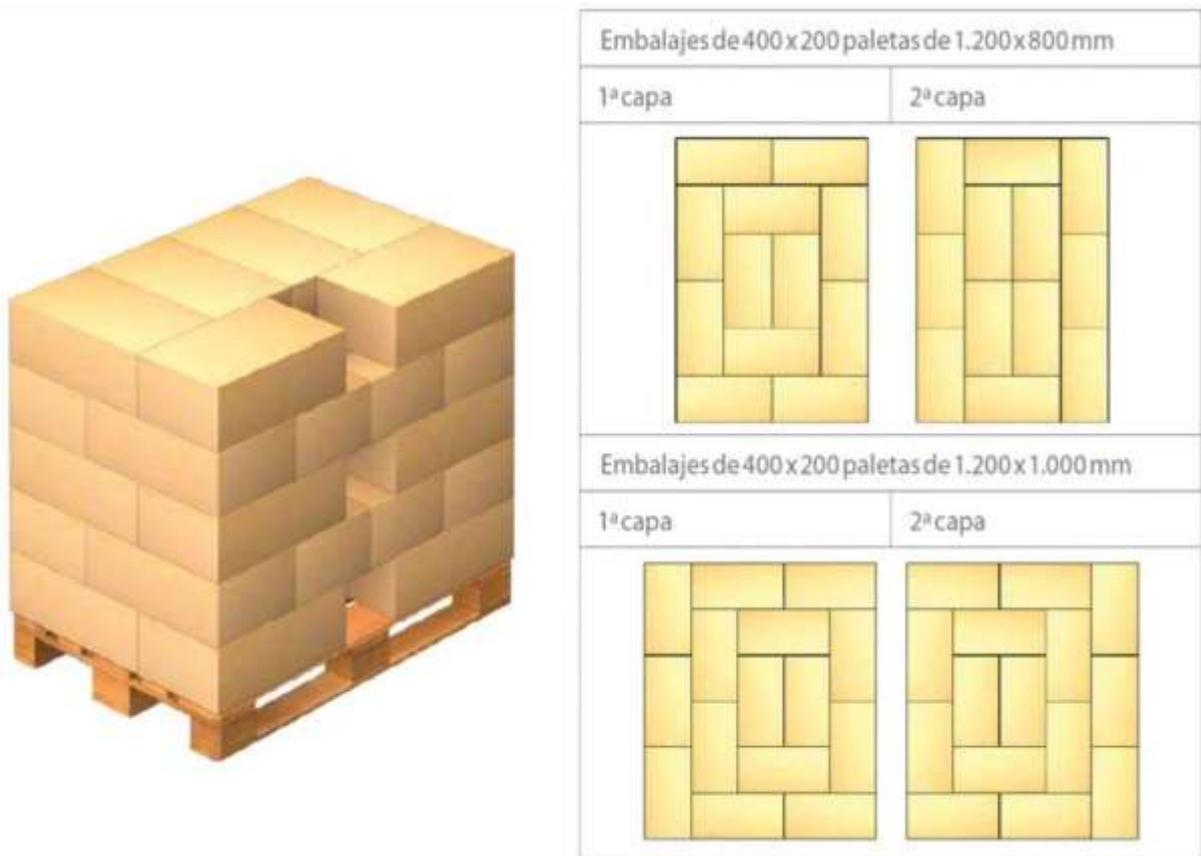
Figura 19. Plano de estiba del pallet para dos tipos de embalajes sugeridos
