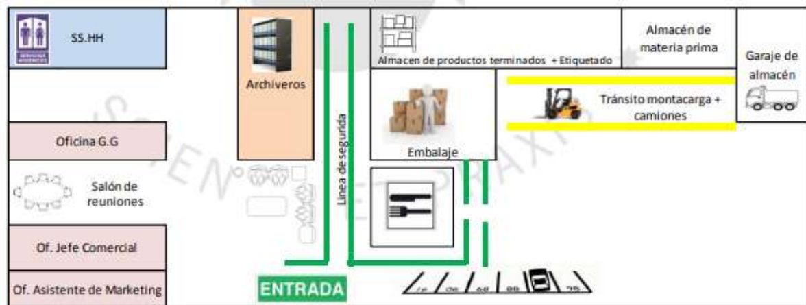
Figura 9 Lay-out de del almacén
