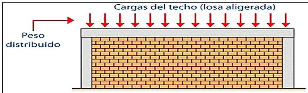
FIGURA N° 9.- CARGAS DISTRIBUIDAS LINEALES
