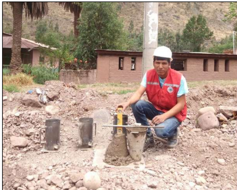
Foto 8. Realización de la prueba de slump
