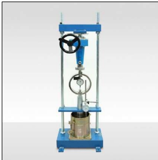
Gráfico 11. Equipo para ensayo CBR
