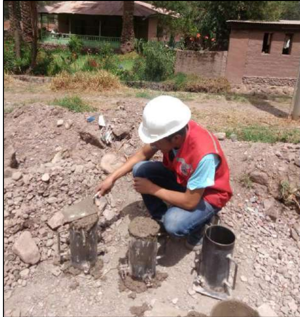
Foto 7. Elaboración de probetas de concreto
