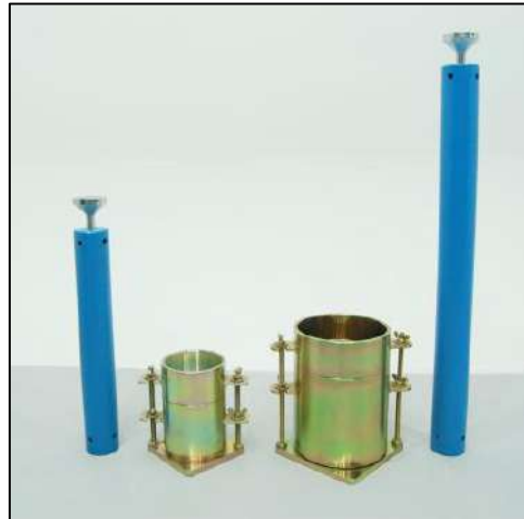
Gráfico 10. Equipo para ensayo Proctor modificado
