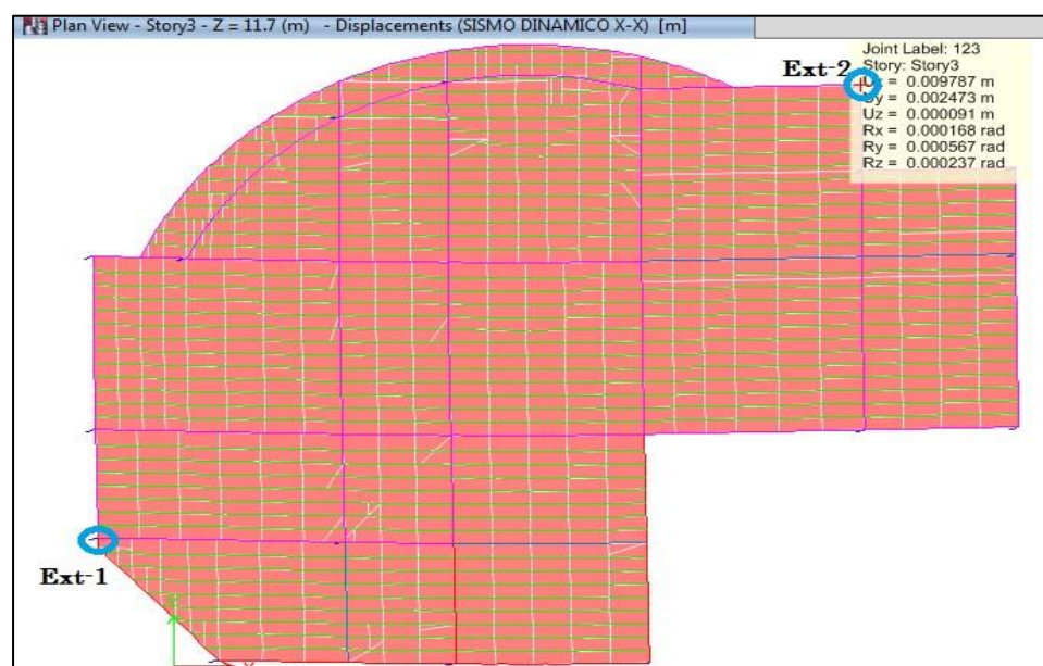
Figura 14. Vista de los desplazamientos máximos en el módulo administrativo. Fuente: Elaboración propia.
