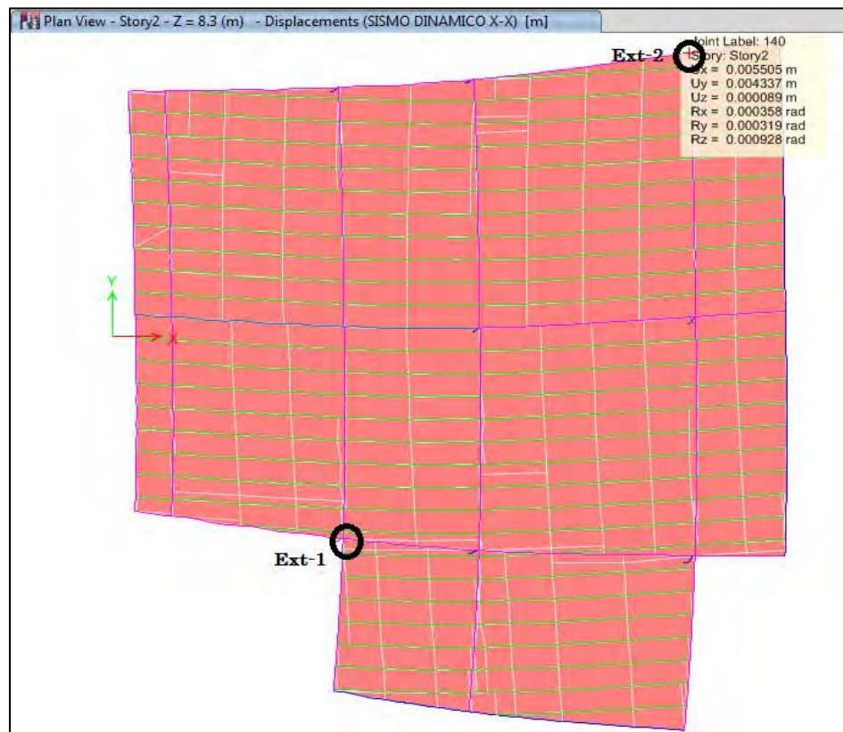
Figura 4. Vista de los desplazamientos máximos en el módulo SS.HH.
