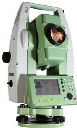
Foto N° 14: Estación total Leica
