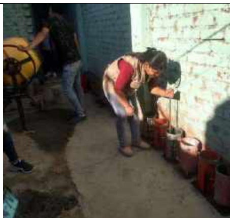
FOTOGRAFIA 33. Chuseo del concreto en las probetas
