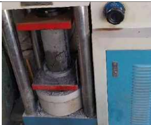
FOTOGRAFIA 01. El tipo de falla es columna y cono
