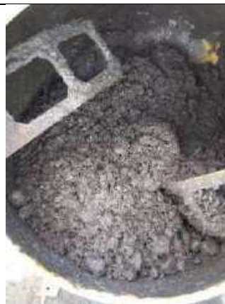
FOTOGRAFIA 32. Vista del concreto con el pet ( el Pet requiere más agua)
