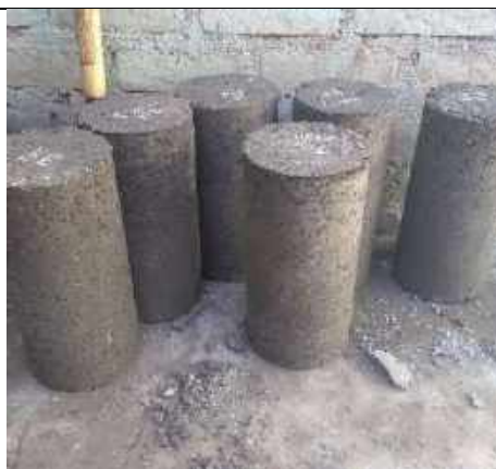
FOTOGRAFIA 38. Concreto con PET que se retiene en la malla n° 10
