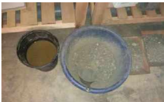
Fotografía 3. El agregado se remojó 12 horas
