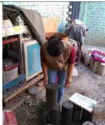
FOTOGRAFIA 01. tomamos las medidas y pesos de las probetas
