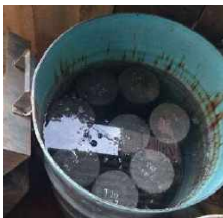
Fotografía 14. Curado de las probetas sumergido en agua
