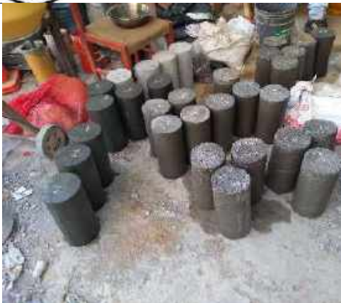
Fotografía 15. Muestra para realizar el ensayo a compresión
