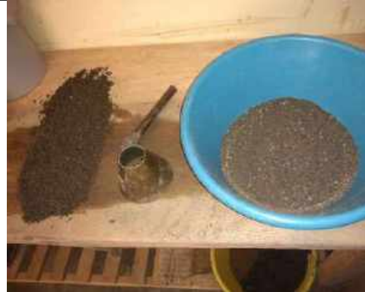
FOTOGRAFIA 08. Realizamos la prueba del cono, hasta encontrar la humedad óptima
