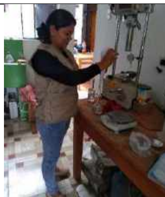
FOTOGRAFIA 18. Se hecho el PET pesado en la fiola con agua
