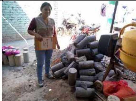
FOTOGRAFIA 01. Probetas rotas a compresión
