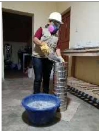
FOTOGRAFIA 13. Se tamizo el PET para obtener lo que se retienen en las mallas n° 10 y 16
