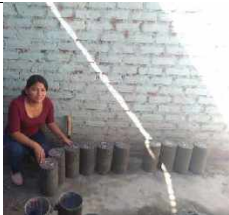
FOTOGRAFIA 36. Desencoframos al día siguiente
