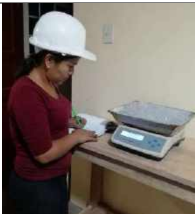
FOTOGRAFIA 14. Después del tamizado se procedió a pesar lo que se retienen en las diferentes mallas
