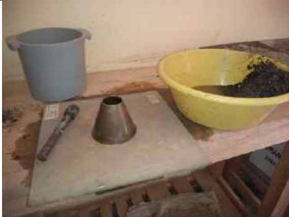
FOTOGRAFIA 07. Después que se saturó el agregado se procedió a secar superficialmente
