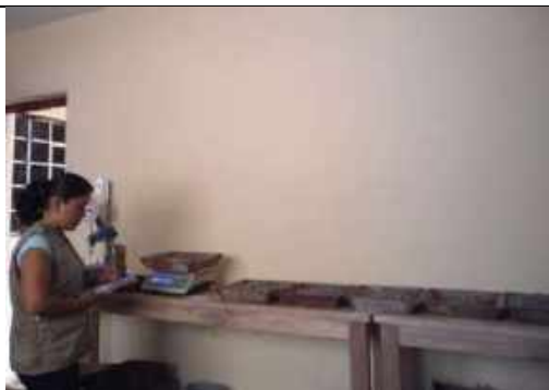
FOTOGRAFIA 03. Pesado del hormigón ya tamizado
