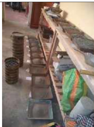
FOTOGRAFIA 02. Tamizado el hormigón
