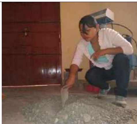
FOTOGRAFIA 01. Cuarteo de hormigón
