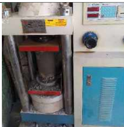
Fotografía 17. Realizando la el ensayo a compresión
