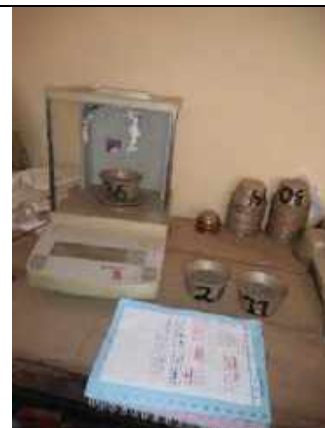
FOTOGRAFIA 12. Una vez que obtuvimos que el agregado tenga la superficie seca lo pesamos y lo secamos en el horno (peso específico y absorción)
