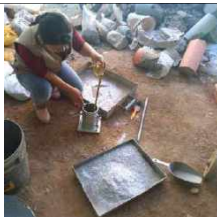
FOTOGRAFIA 28. Se tomaron las mediada del recipiente para calcular el volumen
