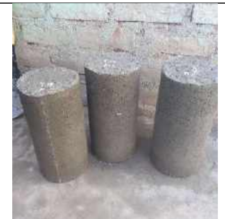
FOTOGRAFIA 39. Concreto con PET que se retiene en la malla n° 16
