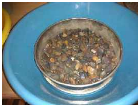
Fotografía 4. Del agregado grueso se eliminó el agua superficial
