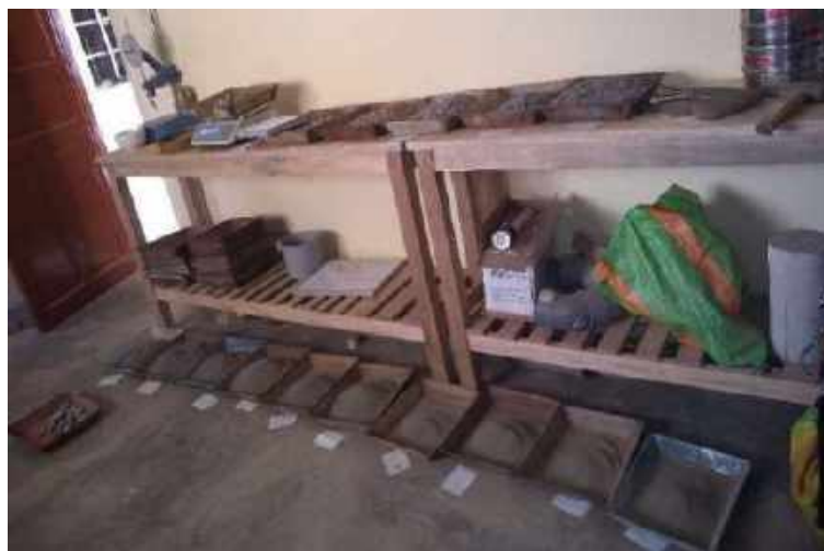
Fotografía 2. Muestra que pasa por las diferentes mallas
