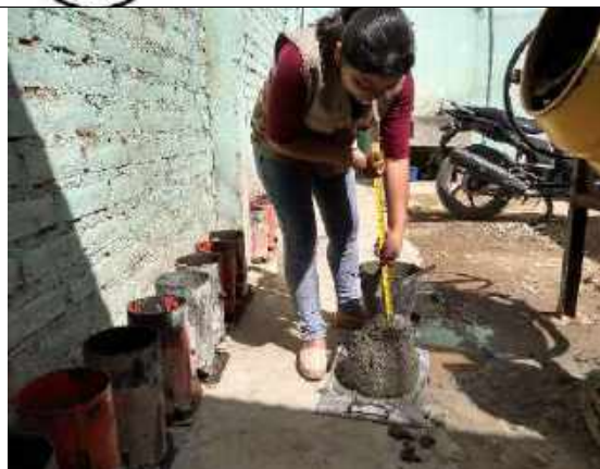
Fotografía 10. Realizando la prueba del slump
