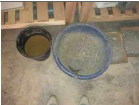
FOTOGRAFIA 05. Se remojo el hormigón por 12 horas para calcular el peso específico
