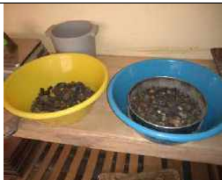
FOTOGRAFIA 06. Se procedió a secar la muestra saturada grueso
