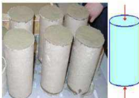
Figura 3. Muestra cilíndrica de concreto para el ensayo de compresión estándar Fuente: Romo P. M
