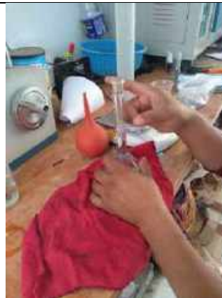
FOTOGRAFIA 20. Estamos eliminando el aire dentro de la fiola
