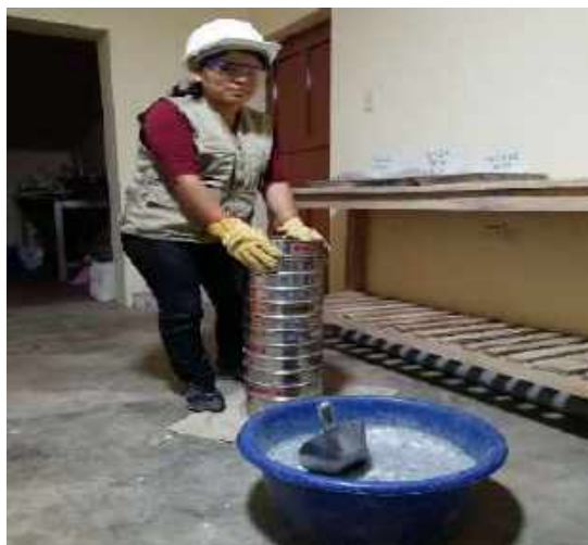
Fotografía 6. Análisis granulométrico del PET
