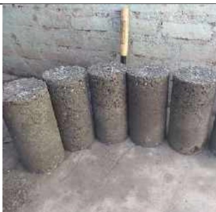
FOTOGRAFIA 37. Concreto con PET que se retiene desde la malla n° 3/8"
