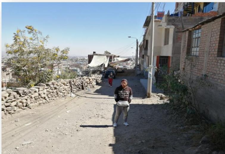
*Nota: Se visualiza el tramo I en el que se realizara la construcción de muros de contención. Se realizó la calicata I para diagnosticar el material existente y el tipo de refuerzo estructural que se aplicara.*
