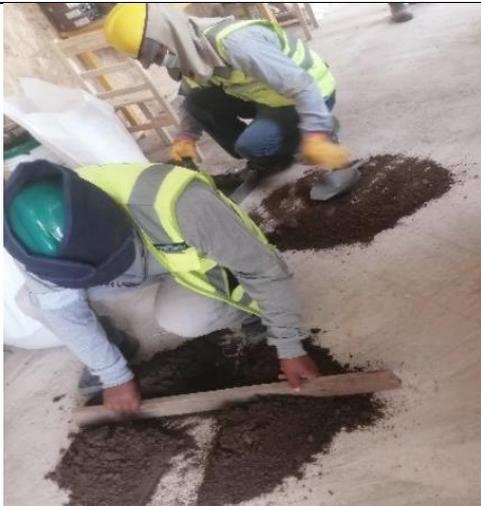
Foto 3: Ensayo de cuarteo
