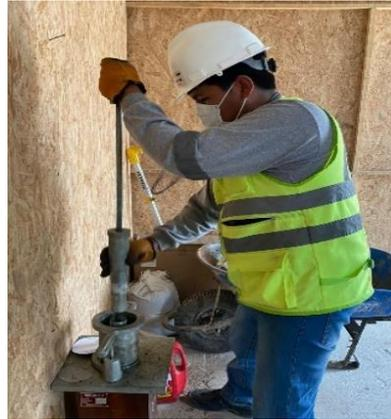
Foto 14: Ensayo de Marshall
