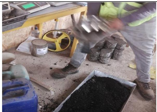
Foto 22: Toma de muestra de asfalto caliente
