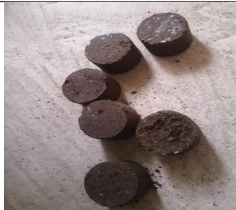
Foto 6: Ensayo de Marshall
