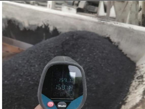
Foto 26: Toma de temperatura de asfalto en planta
