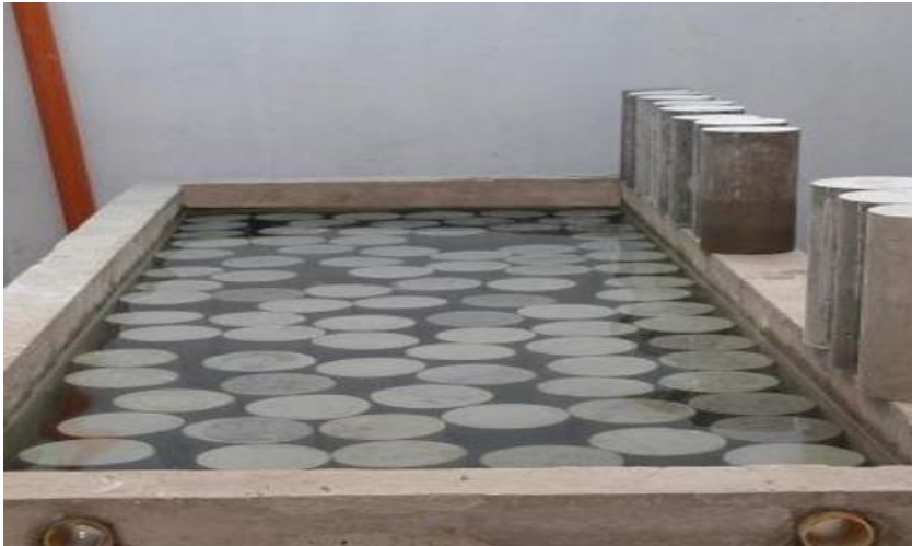
Figura 9: Proceso de curado de probetas
