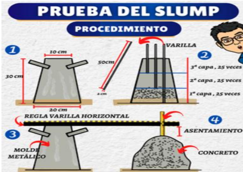
Figura 2: Prueba de Slump
