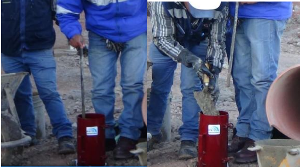
FOTOGRAFIA N° 12: SE OBSERVA EL LLENADO Y COMPACTADO EN TRES CAPAS DE IGUAL VOLUMEN DEL CONCRETO.
