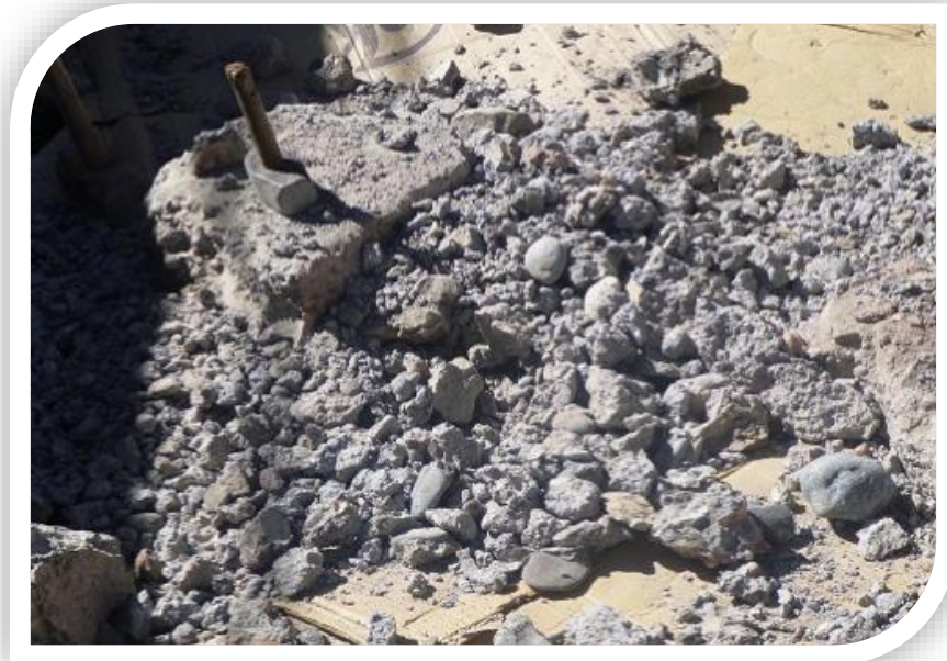
FOTOGRAFIA N° 9: SE OBSERVA TRITURADO DE CONCRETO RECICLADO PARA SU USO EN LOS ENSAYOS.
