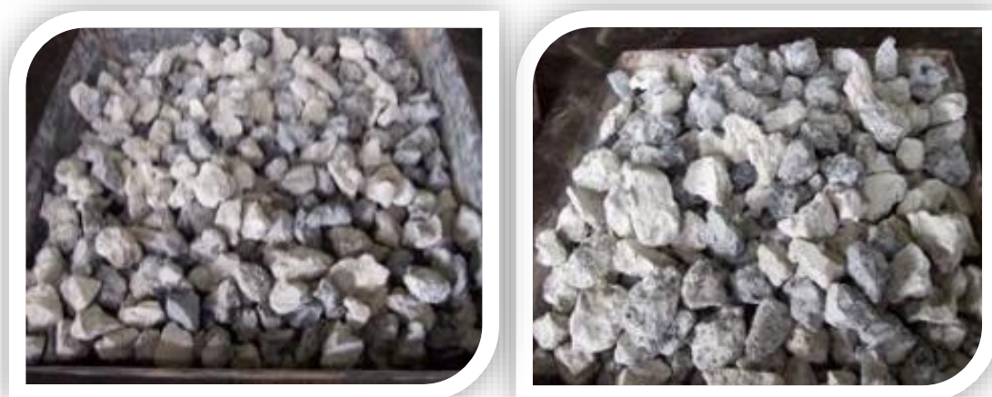
FOTOGRAFIA N° 10: SE OBSERVA TAMAÑOS DE PARTÍCULAS DE AGREGADO RECICLADO.
