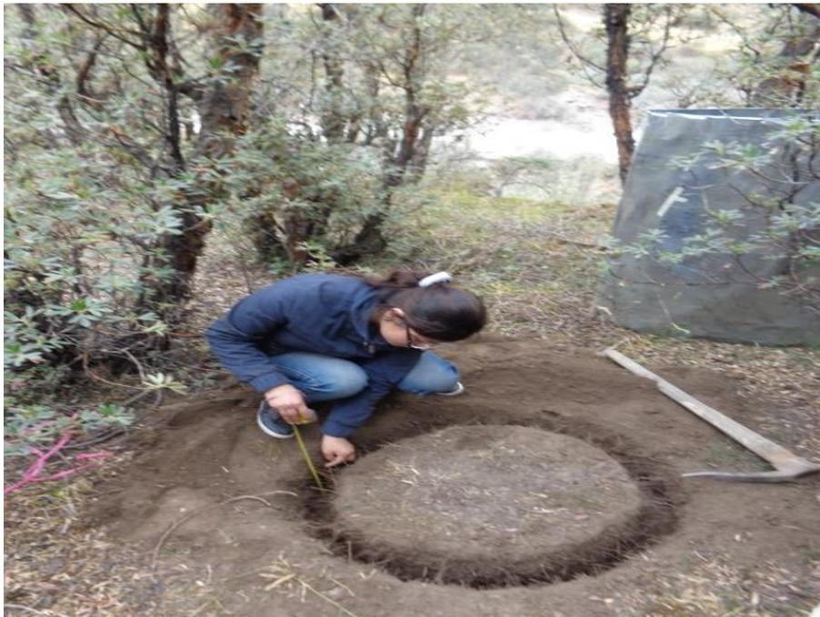
*IMAGEN N°9: Prueba de infiltración realizada en campo utilizando el Método de Porchet*
