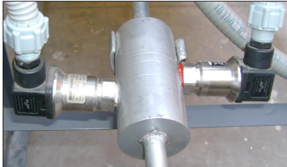
Figura 17 Transmisor de presión Baumer.
