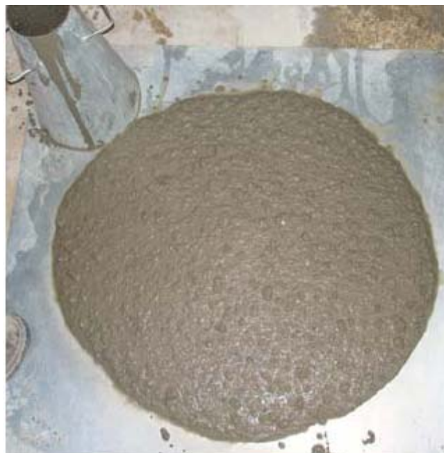
Figura 6-Resultado final del ensayo de escurrimiento
