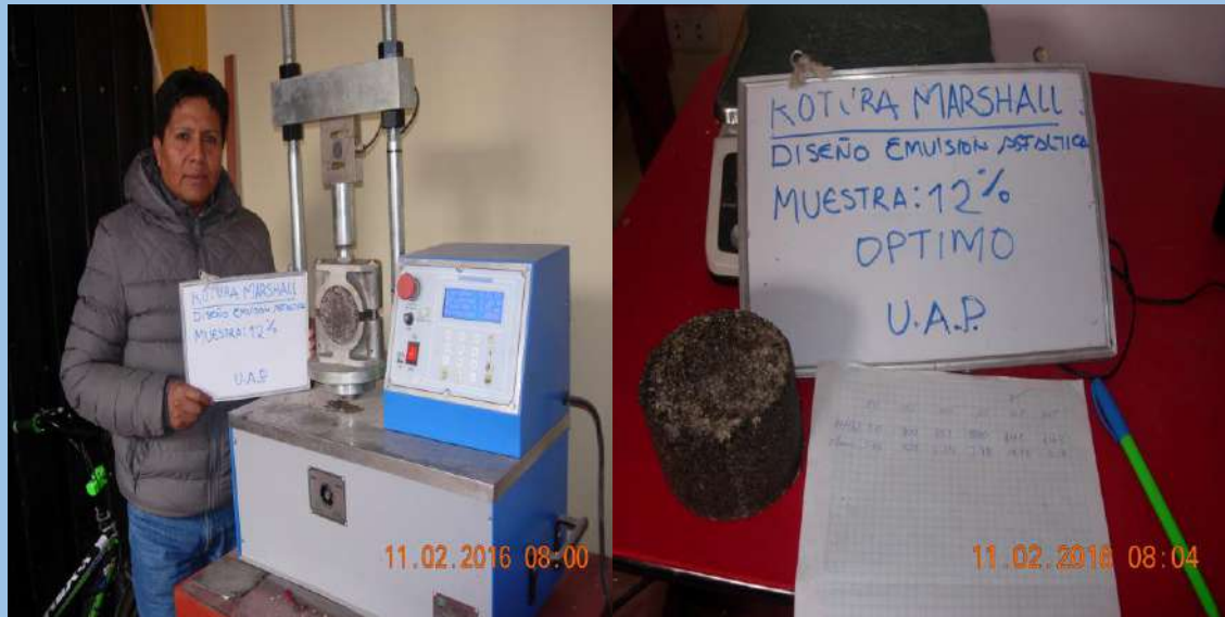
FIGURA N° 38 , En la fotografía se observa el equipo Marshall, cuyos resultados se dan por el principio de corte por compresión en la rotura de los testigos y los resultados a obtener.
