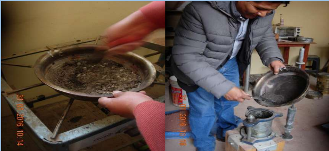
FIGURA N° 34, En la fotografía se observa el mesclado de los componentes considerados para la elaboración de briquetas con los especímenes considerados.
