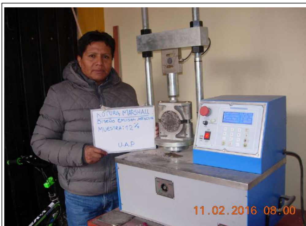
VISTA 28: En la fotografía se observa la rotura del testigo con 12% de asfalto del diseño de mezcla Slurry Seal Altiplanico, en el equipo de rotura Marshall.
