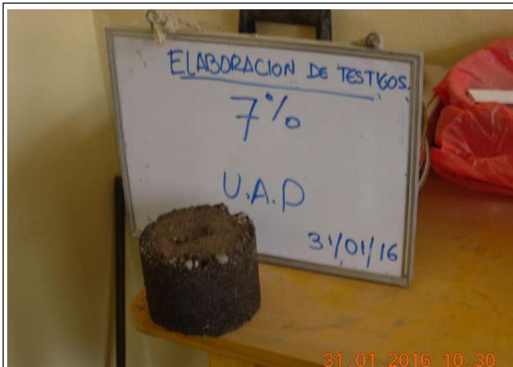
VISTA 23: En la fotografía se observa el testigo con 7% de asfalto, en el diseño de mezcla Slurry Seal Altiplánico, elaborado en el laboratorio de mecánica de suelos Consorcio Mañazo.
