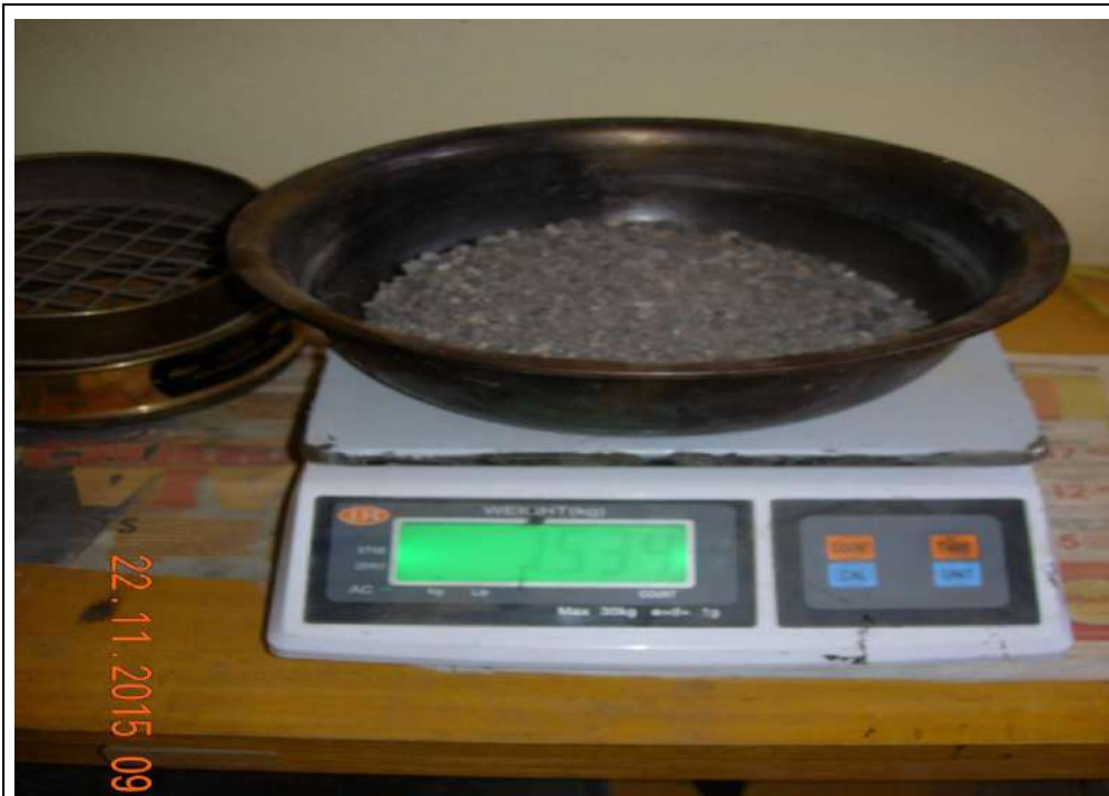
VISTA 07: En la fotografía se observa el pesado del agregado fino, correspondiente de la cantera Isla de la ciudad de Juliaca.
