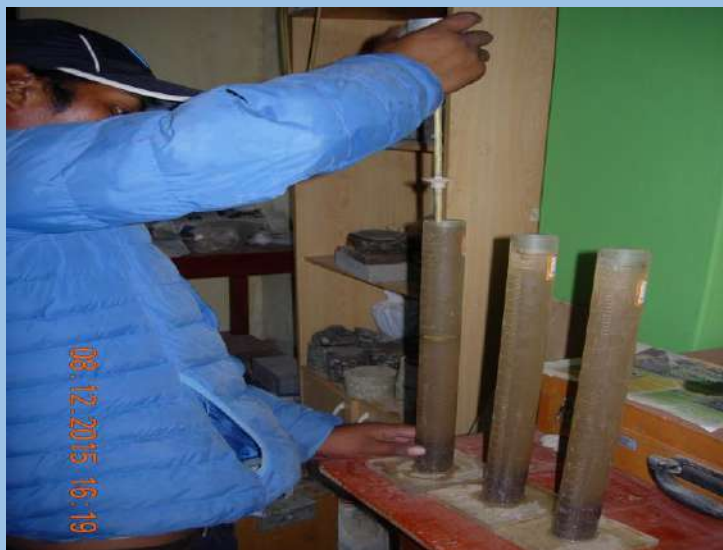
FIGURA N° 28 , En la fotografía se observa el ensayo Equivalente de Arena del agregado fino, de las 3 muestras elaboradas.
