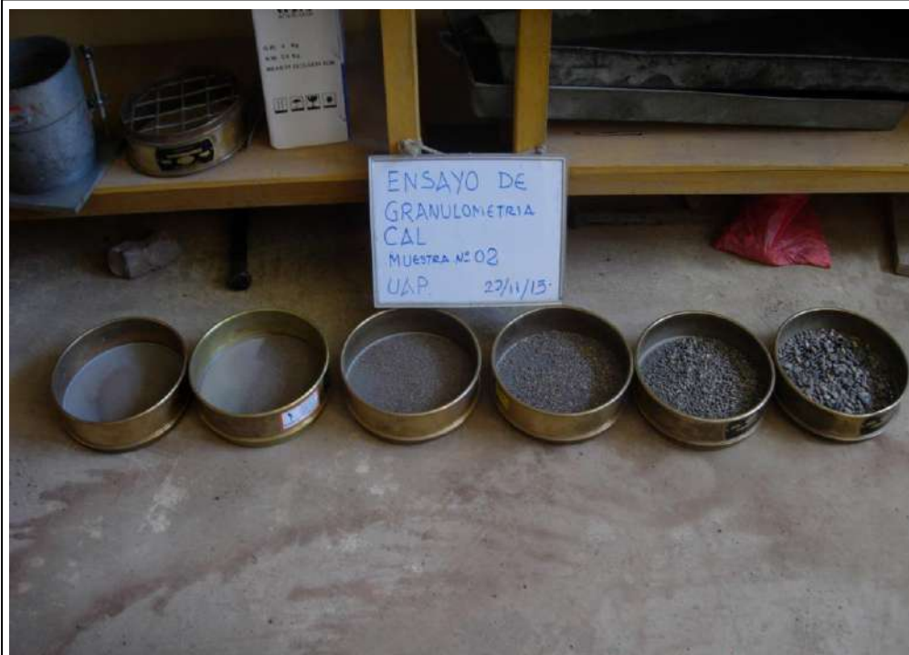
VISTA 10: En la fotografía se observa el material seleccionado por el método de ensayo de granulometría del agregado considerado correspondiente a la cantera Isla rio Unocolla de la ciudad de Juliaca, en las 06 mallas.
