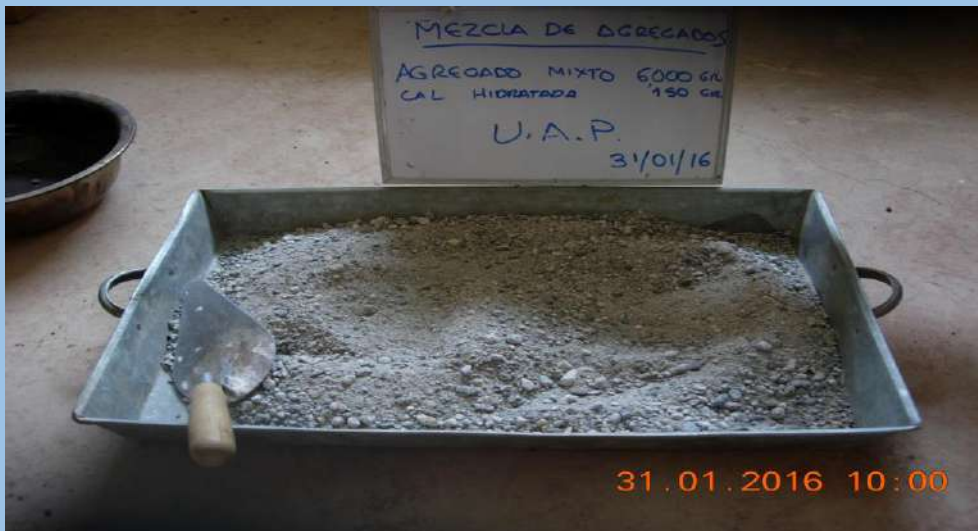
FIGURA N° 32, En la fotografía se observa la mezcla del agregado mixto y la cal hidratada (filler), antes de someter al ensayo.
