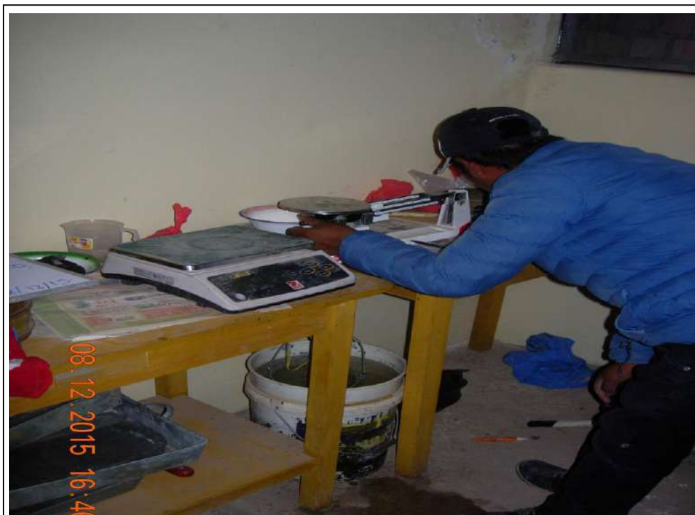
VISTA 16: En la fotografía se observa el ensayo de peso específico del material grueso, donde se observa el material sumergido en agua y su peso.
