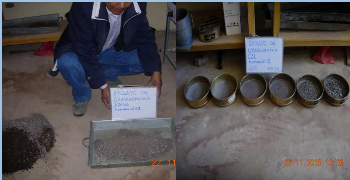
FIGURA N° 26, En la fotografía se observa el ensayo granulométrico del agregado fino y las mallas utilizadas.
