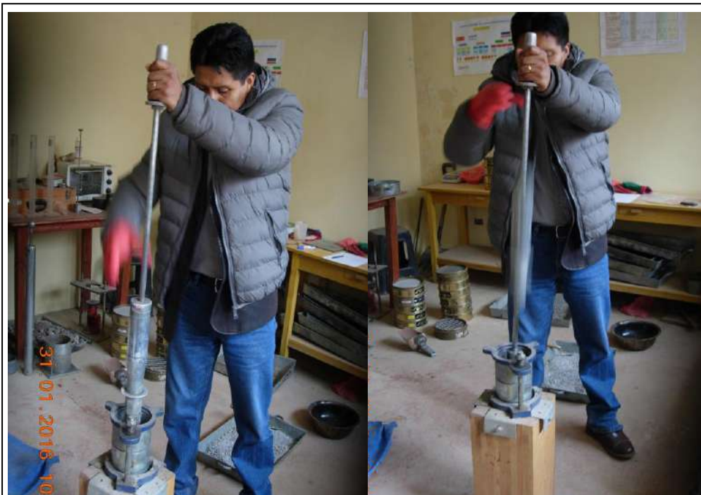
VISTA 22: En la fotografía se observa el ensayo del martillo, donde se deja caer 75 golpes a los testigos en ambos lados, el que determinara la resistencia del espécimen con un total 150 golpes.
