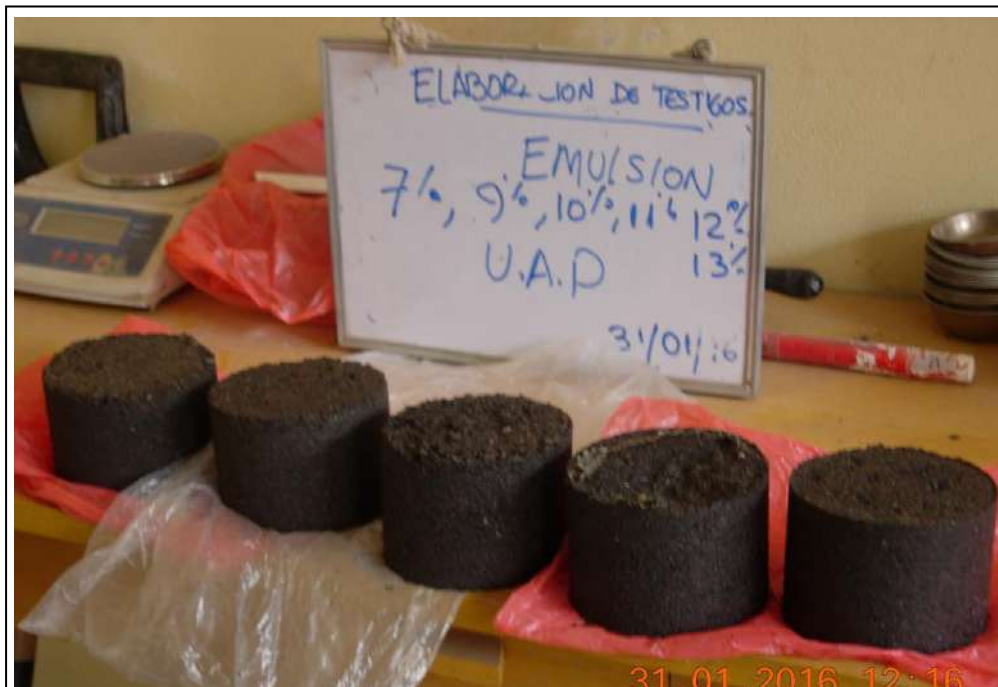
VISTA 24: En la fotografía se observa la elaboración de 06 testigos del diseño Slurry Seal Altiplánico, con agregados que corresponden a la cantera Isla del río Unocolla de la ciudad de Juliaca, con porcentajes de 7%, 9%, 10%, 11%, 12%, 13%, 14 y 15% de asfalto.
