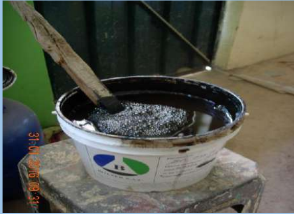
FIGURA N° 33 , En la fotografía se observa el Mortero Asfáltico utilizado para el diseño de mezcla, cuyo fabricante es BITUPER S.A.C, producto utilizado emulsión Catiónica BP-CSS-1H.
