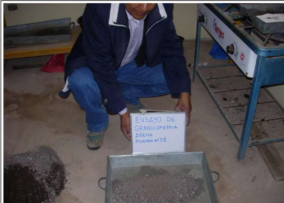
VISTA 03: En la fotografía se observa el ensayo de granulometría, correspondiente a los agregados, arena proveniente de la cantera Isla, rio Unocolla de la ciudad de Juliaca.
