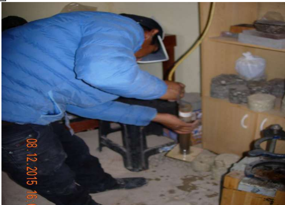
VISTA 14: En la fotografía se observa colocando el material fino en los tubos de ensayo equivalente de arena.
