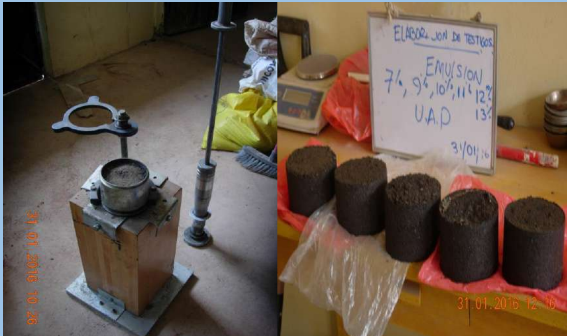
FIGURA N° 36 , En la fotografía se observa la elaboración de los testigos de los especímenes considerados, en diferentes porcentajes de emulsión asfáltica.
