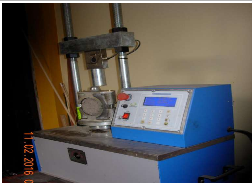
VISTA 26 En la fotografía se observa el equipo utilizado para el ensayo de rotura Marshall, donde se determinaron la resistencia, fluencia porcentaje de vacíos y el peso total de los especímenes.
