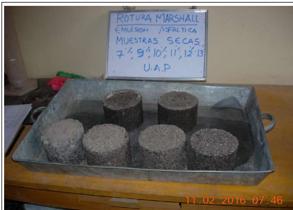
VISTA 25: En la fotografía se observa los testigos de diseño Slurry Seal, con diferentes porcentajes de asfalto, los que serán sometidos al ensayo de Rotura Marshall.
