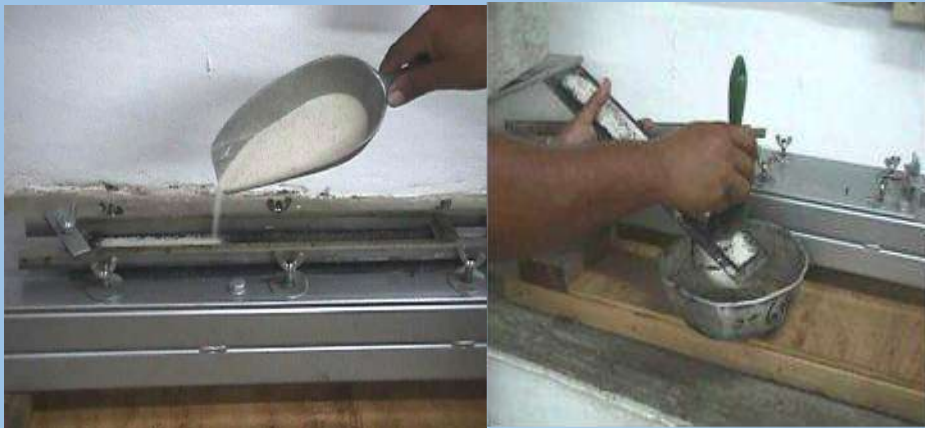
Figura N° 22 Ensayo de Rueda cargada aplicado al asfalto
