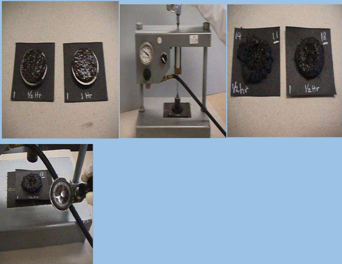
Figura N° 20 Ensayo de Cohesión
