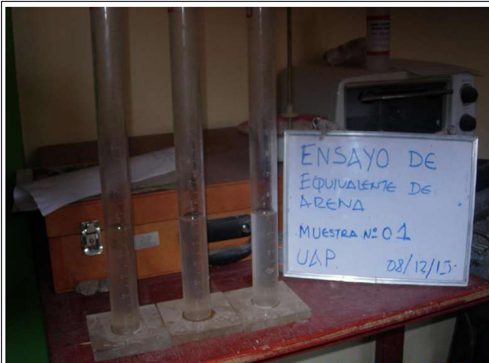
VISTA 13: En la fotografía se observa el ensayo de Equivalente de Arena, de la muestra 01.
