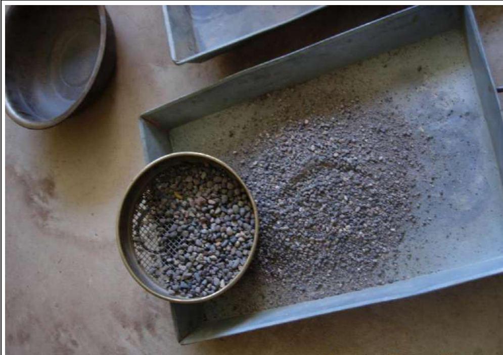
VISTA 9: En la fotografía se observa el ensayo granulométrico del agregado considerado para las 02 muestras, correspondiente de la cantera Isla rio Unocolla de la ciudad de Juliaca.
