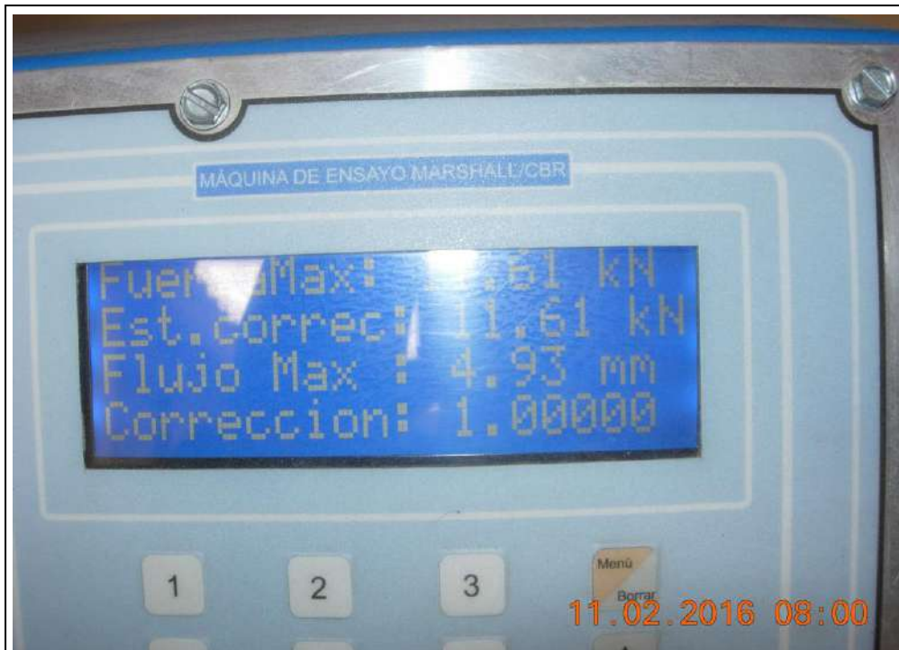
VISTA 27: En la fotografía se observa los parámetros considerados en la rotura Marshall, donde se considera fuerza máxima, en kiloneuton, flujo máximo y su respectiva corrección.
