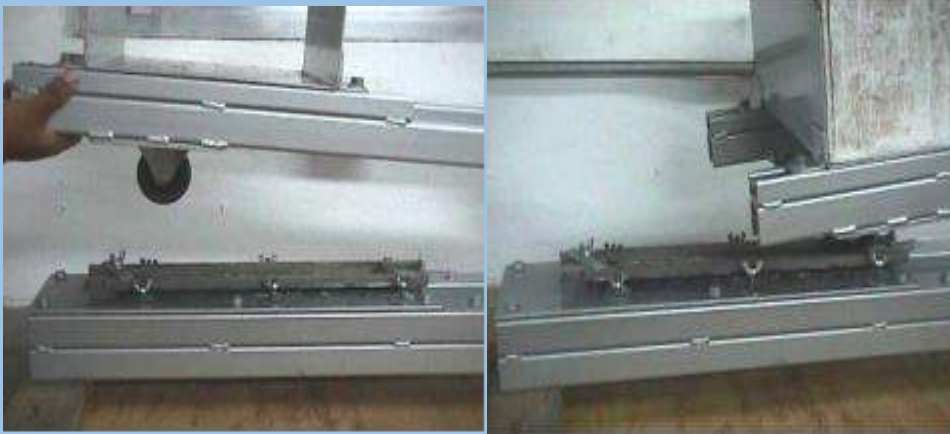
Figura N° 22 Ensayo de Rueda cargada aplicado al asfalto
