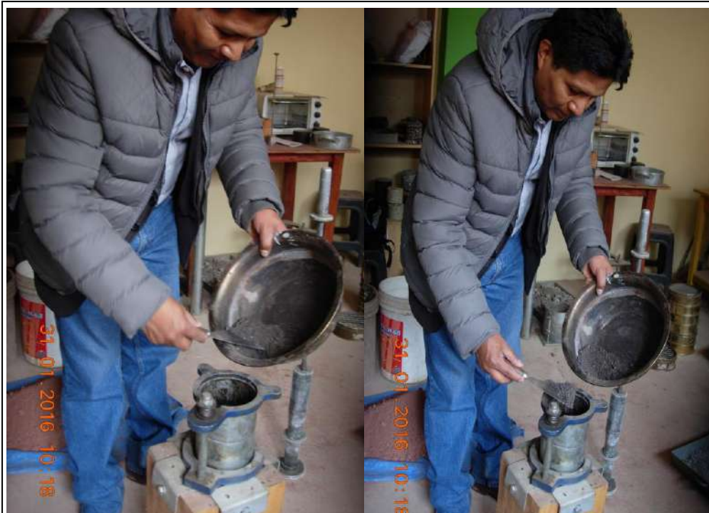
VISTA 21: En la fotografía se observa la elaboración de los testigos o briquetas, para luego proceder al ensayo de los 75 golpes de martillo a cada lado.
