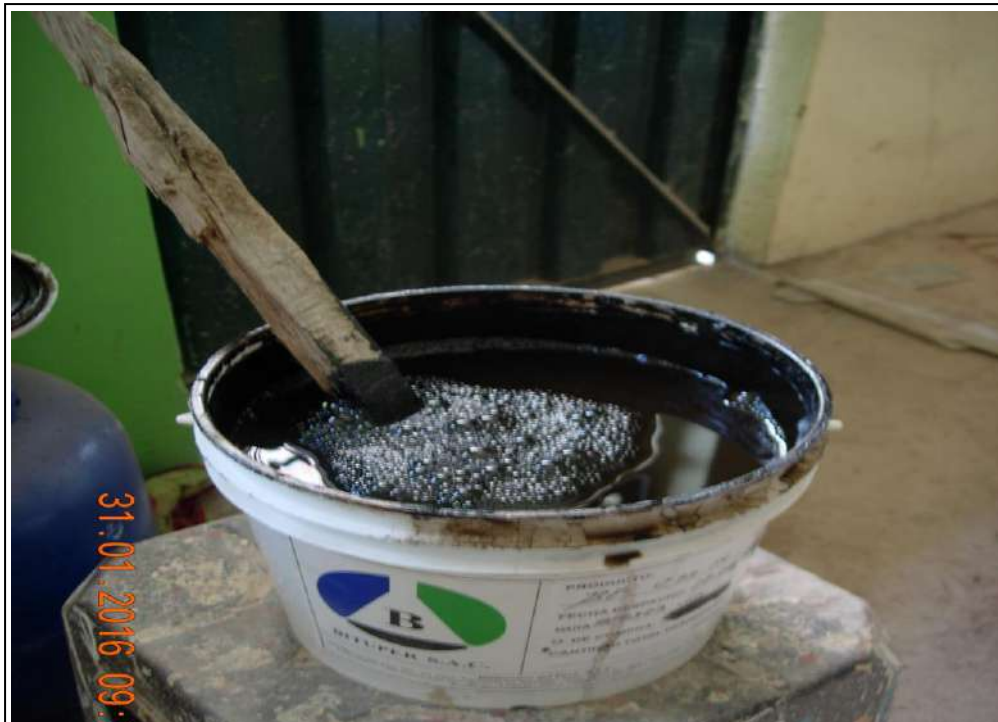
VISTA 17: En la fotografía se observa el batido del emulsificante, producto adquirido de BITUPER SAC. Emulsión asfáltica catiónica BP-CSS-1H, utilizada en el diseño de mezcla Slurry Seal Altiplanico.
