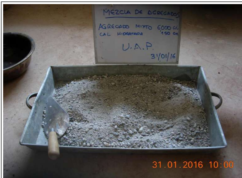
VISTA 18: En la fotografía se observa el ensayo de mezcla de agregados mixto y la cal hidratada, para ello se ha determinado el peso para su diseño.
