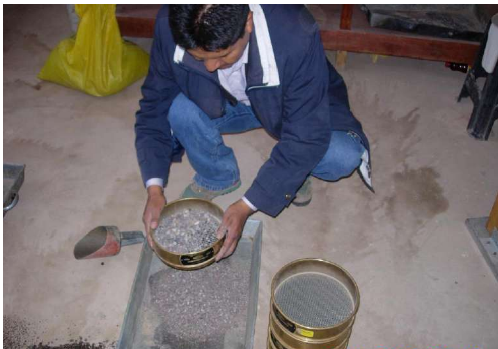
VISTA 08: En la fotografía se observa el tamizado del agregado grueso y fino, con el uso de las mallas 3/8", 20, 40, 60, 80 y 100, el que corresponde a la cantera Isla rio Unocolla de la ciudad de Juliaca.
