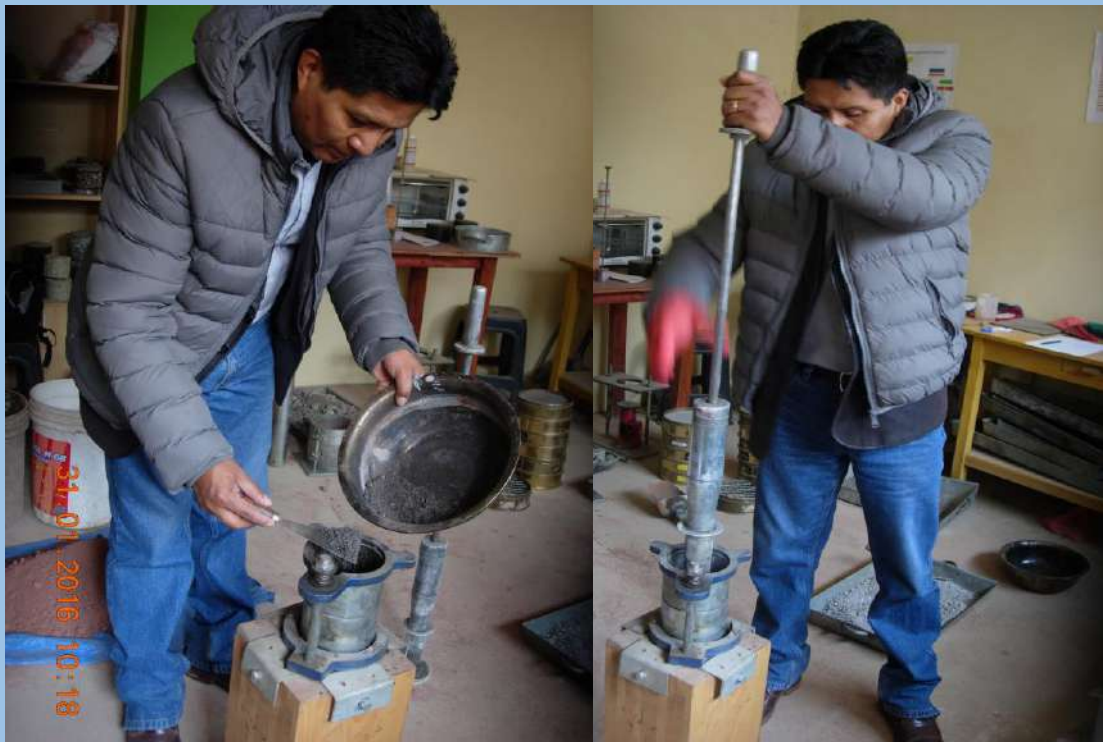
FIGURA N° 35, En la fotografía se observa la elaboración de testigos de los especímenes considerados, a 75 golpes en cada lado.
