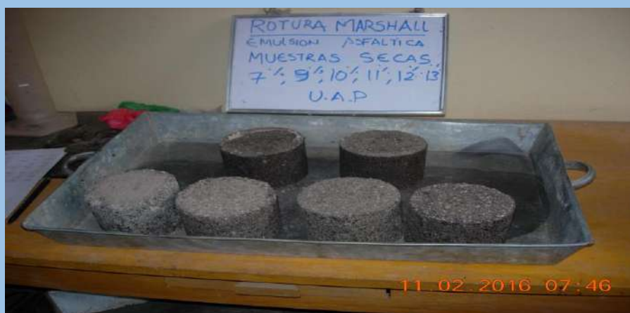
FIGURA N° 37 , En la fotografía se observa los testigos secos en un periodo de 24 horas, para luego someterlos al Ensayo Marshall.
