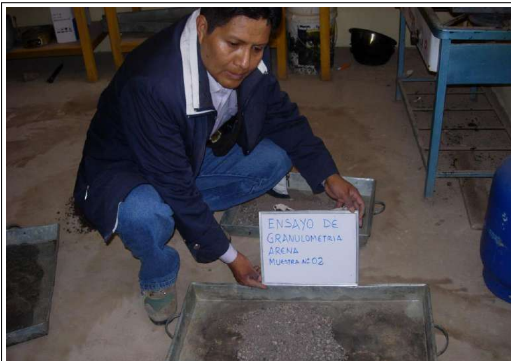
VISTA 04: En la fotografía se observa el ensayo de granulometría, correspondiente a la muestra 2, proveniente de la cantera Isla rio Unocolla de la ciudad de Juliaca.
